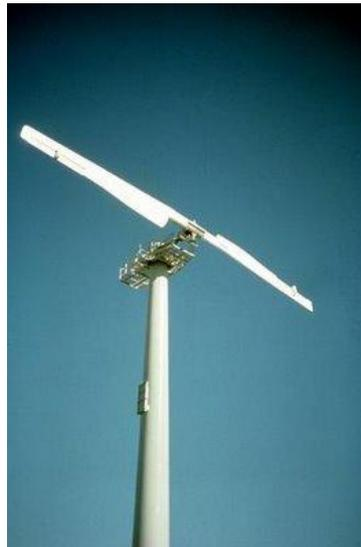
Figura 9: Aerogenerador de dos palas
