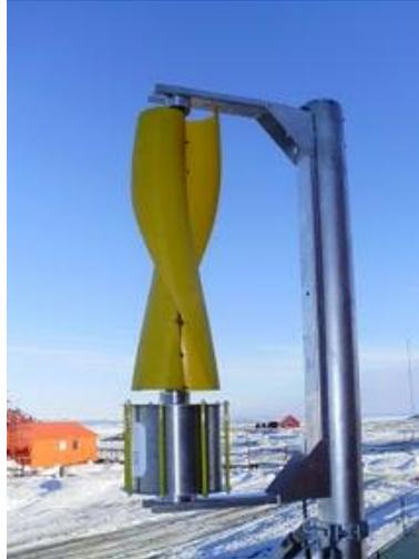
Figura 13: Rotor Savonius con palas torsionadas.
