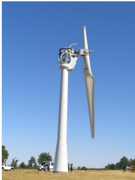
Figura 8: Aerogenerador de una pala
