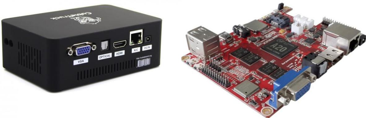
Ilustración 6. Placa Cubietruck con y sin case
