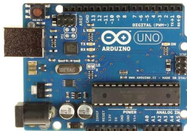
Ilustración 8. Placa Arduino UNO
