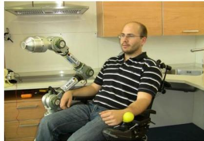
Figura 2. 4 Silla de ruedas con anclaje DS en raíl
