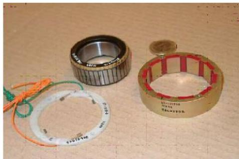
Figura 2. 10 Torque Motor
