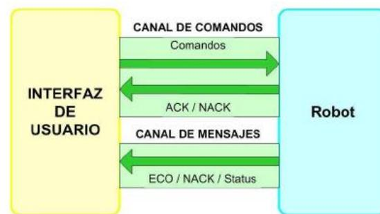
Figura 2. 15 Canales de comunicación entre HMI y robot
