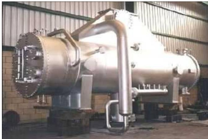
**Ilustración 26. Condensador de superficie**
