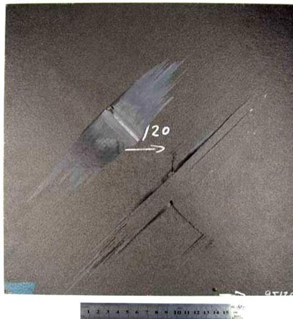
Figura 1.4: Zona de impacto de un laminado de 4mm de espesor, impactada por un proyectil de 50mm de diámetro a 200m/s.
