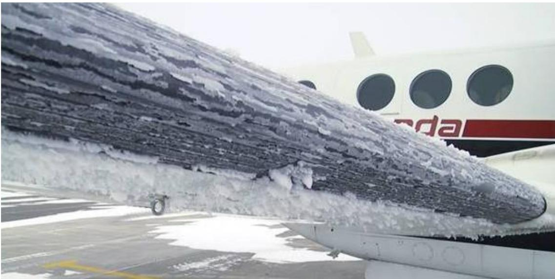
Figura 1.3: Hielo acumulado en el borde de ataque de un avión de hélices.
