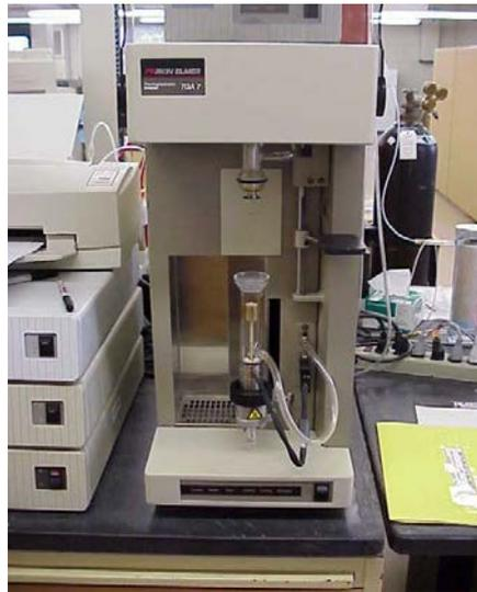
**Figura 13:** Sistema termogravimétrico Perkin Elmer TGA.
