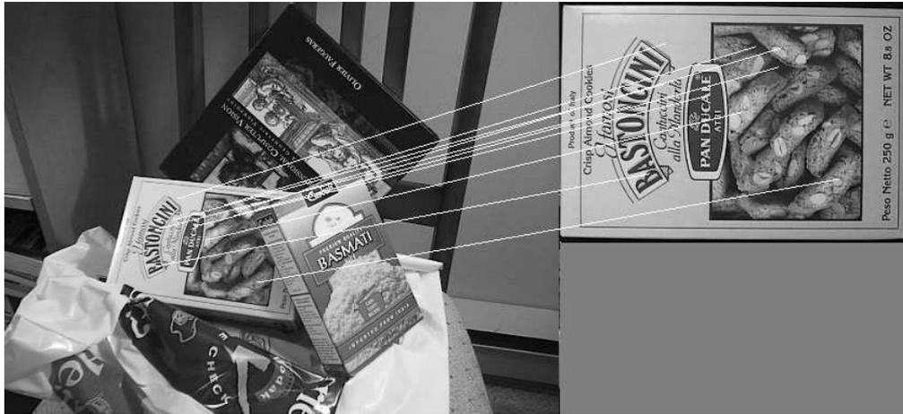
Figura 4.50: *Búsqueda de una caja de pan en una escena con varios objetos por el software implementado en este proyecto con 3 octavas, 8 niveles por octava y un valor umbral de 0.8.*
