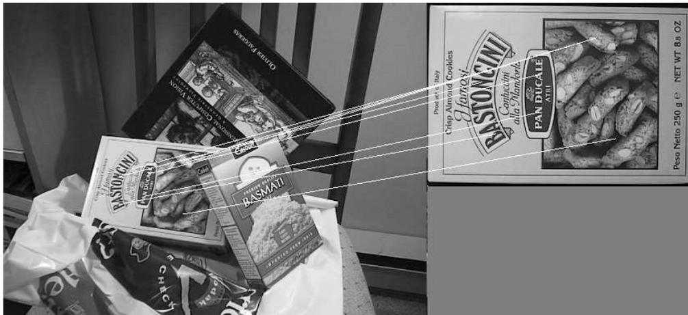
Figura 4.49: *Búsqueda de una caja de pan en una escena con varios objetos por el software implementado en este proyecto con 3 octavas, 6 niveles por octava y un valor umbral de 0.8.*
