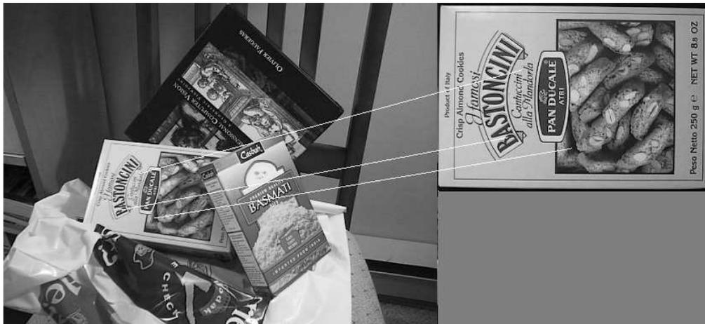
Figura 4.47: *Búsqueda de una caja de pan en una escena con varios objetos por el software implementado en este proyecto con 3 octavas, 10 niveles por octava y un valor umbral de 0.7.*
