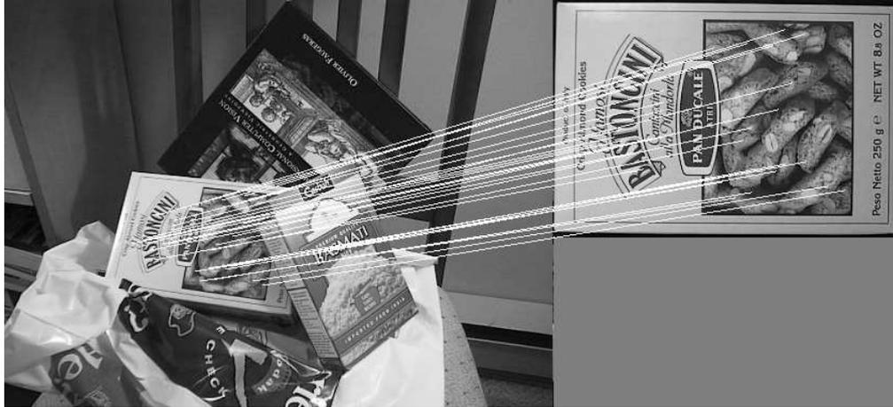
Figura 4.42: *Búsqueda de una caja de pan en una escena con varios objetos por el software implementado en este proyecto con -1 octava, 3 niveles por octava y un valor umbral de 0.7.*
