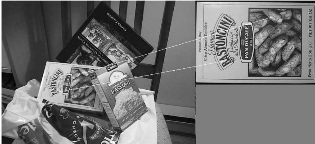
Figura 4.44: *Búsqueda de una caja de pan en una escena con varios objetos por el software implementado en este proyecto con 3 octavas, 3 niveles por octava y un valor umbral de 0.7.*
