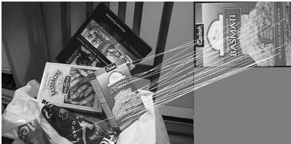
Figura 4.55: *Búsqueda de una caja de arroz basmati en una escena con varios objetos por el software implementado en este proyecto con -1 octava, 3 niveles por octava y un valor umbral de 0.8.*
