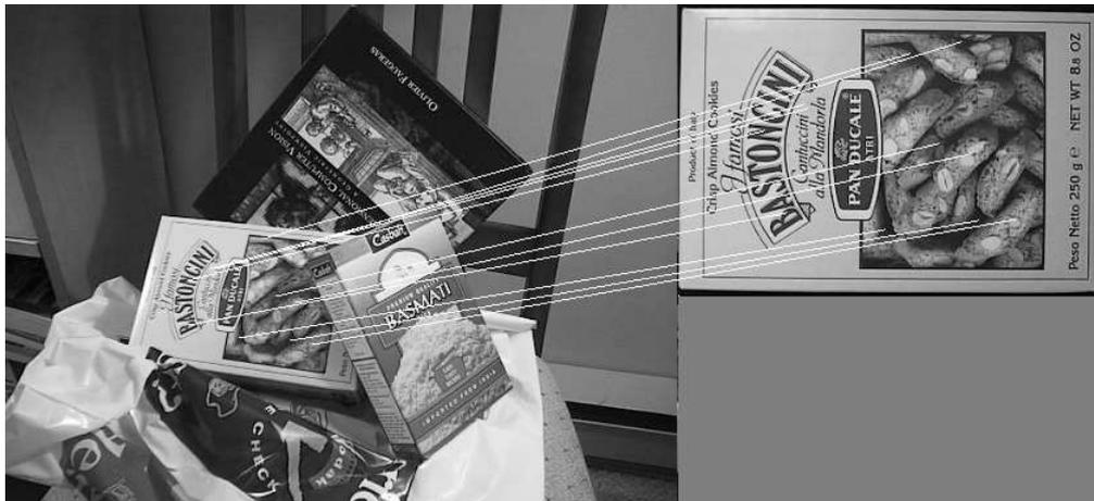
Figura 4.51: *Búsqueda de una caja de pan en una escena con varios objetos por el software implementado en este proyecto con 3 octavas, 10 niveles por octava y un valor umbral de 0.8.*
