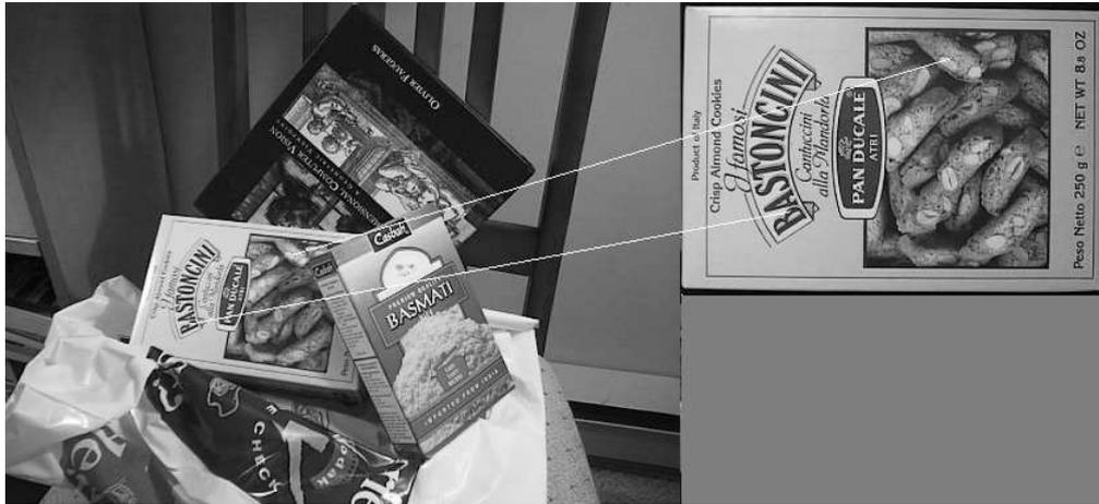
Figura 4.45: *Búsqueda de una caja de pan en una escena con varios objetos por el software implementado en este proyecto con 3 octavas, 6 niveles por octava y un valor umbral de 0.7.*
