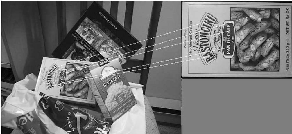
Figura 4.48: *Búsqueda de una caja de pan en una escena con varios objetos por el software implementado en este proyecto con 3 octavas, 3 niveles por octava y un valor umbral de 0.8.*
