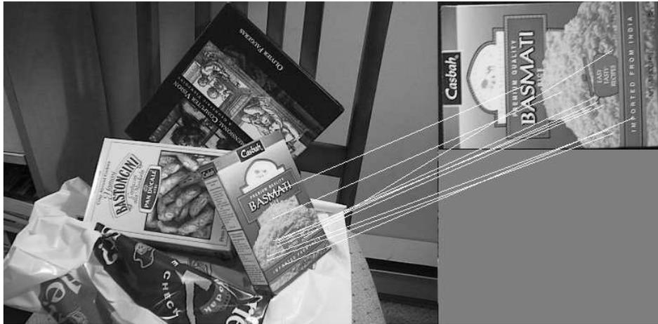
Figura 4.54: *Búsqueda de una caja de arroz basmati en una escena con varios objetos por el software implementado en este proyecto con -1 octava, 3 niveles por octava y un valor umbral de 0.7.*
