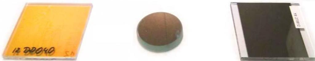
**Figura 23. Muestras caracterizadas de espejos basados en sustrato de vidrio. DD040: dieléctrico puro (izquierda); AR100: aluminio + cuarzo (centro); DH100: aluminio + multicapa dieléctrica (derecha).**
