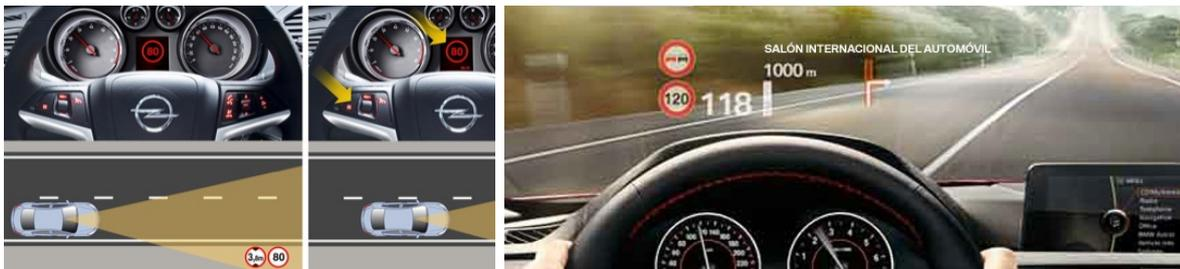
**Figura 3:** Esquema con el monitor del Opel Insignia para la monitorización del límite de velocidad (imagen de la izquierda) y fotografía con la proyección sobre el parabrisas de la información de limitación de velocidad, prohibición de adelantar, e información del navegador en un vehículo del fabricante BMW (imagen de la derecha). Ambas imágenes se han obtenido de la página del correspondiente fabricante.
