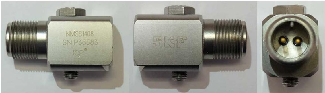
Figura 3.29. Detalle del acelerómetro utilizado desde diferentes vistas.
