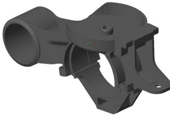
Figura 3.12. Caja de grasa del bogie tipo Y237B.
