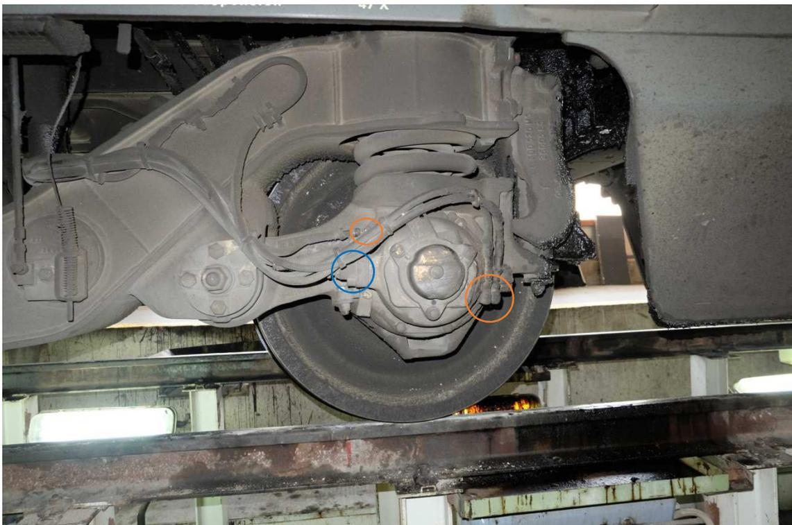
Figura 3.22. Vista general de los sensores de la rueda 47X.
