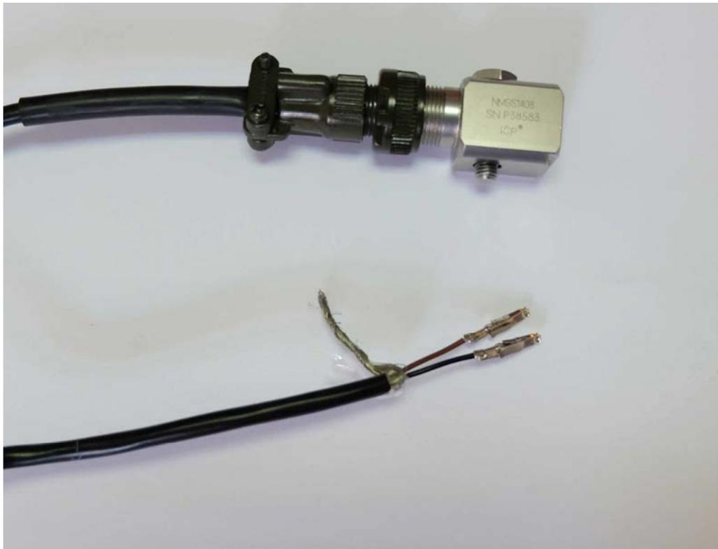
Figura 3.31. Acelerómetro conectado al cable y detalle del otro extremo del cable.
