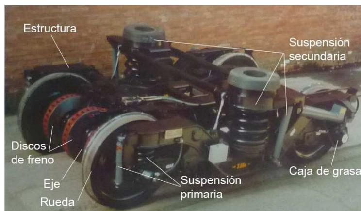
Figura 2.3. Elementos básicos de un bogie ferroviario.
