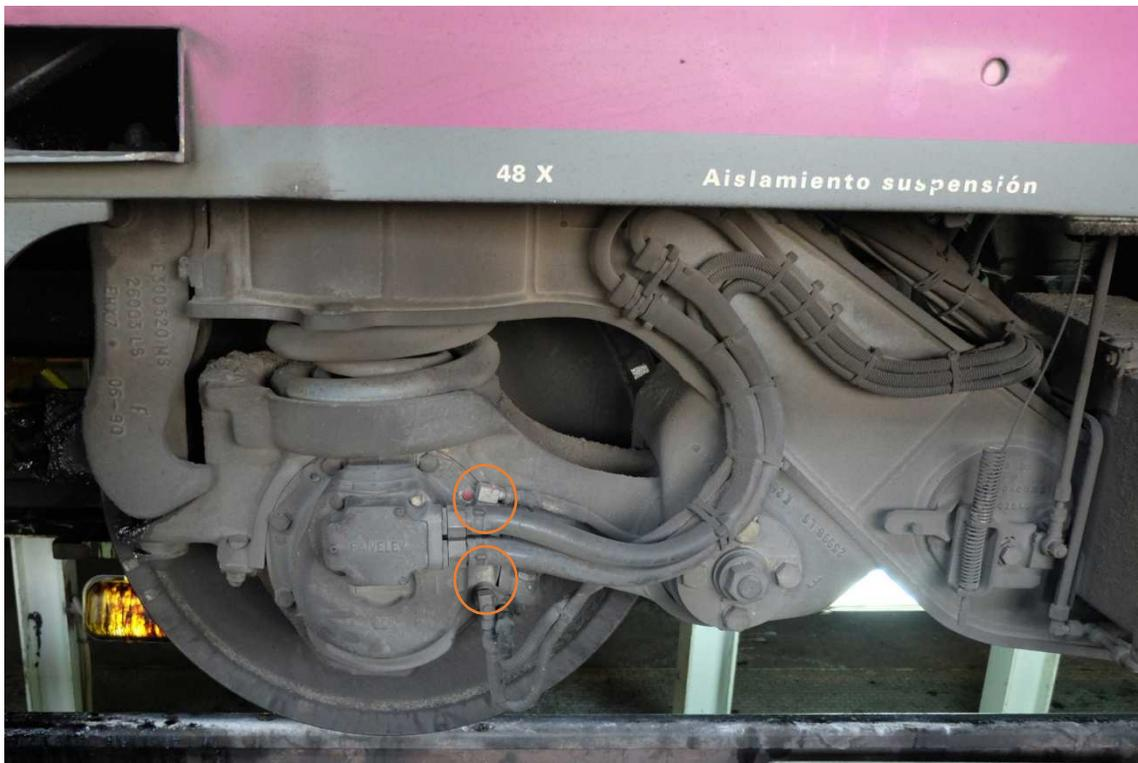
Figura 3.26. Vista general de los sensores de la rueda 48X.
