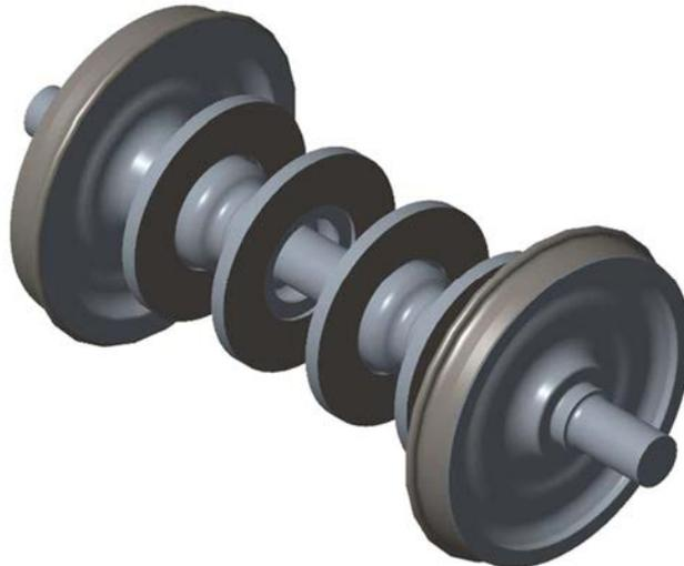
*Figura 3.10. Eje montado del bogie tipo Y237B.*
