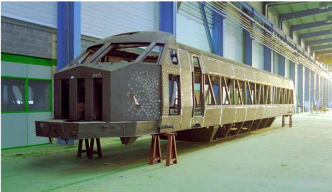
Figura 3.3. Estructura de una cabeza tractora de la serie 100 durante su construcción [282].
