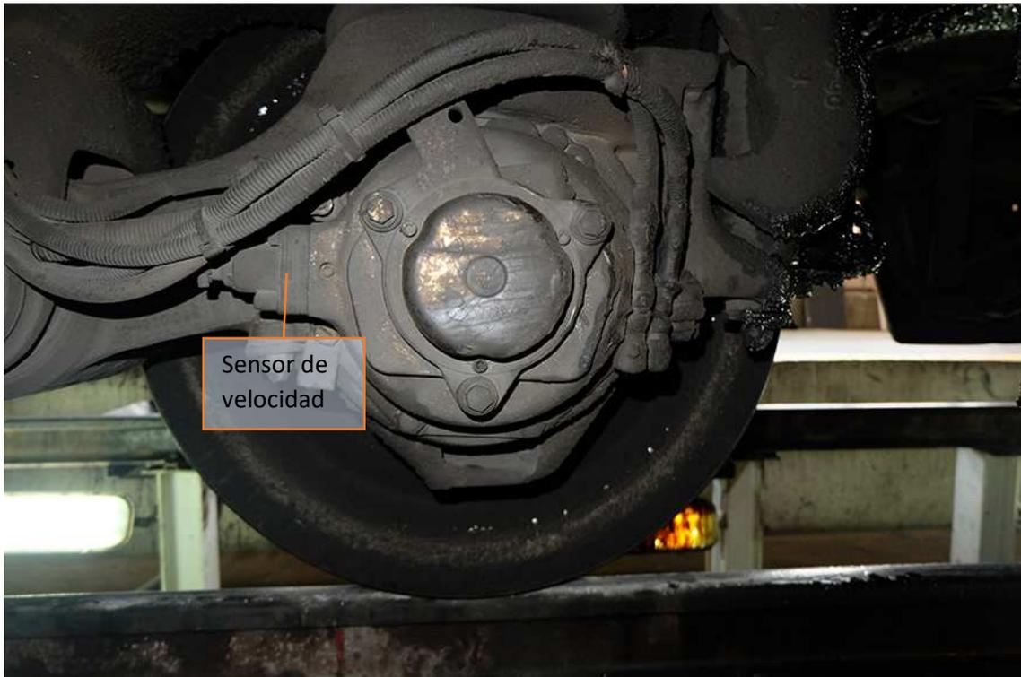
Figura 3.25. Detalle del sensor de velocidad.
