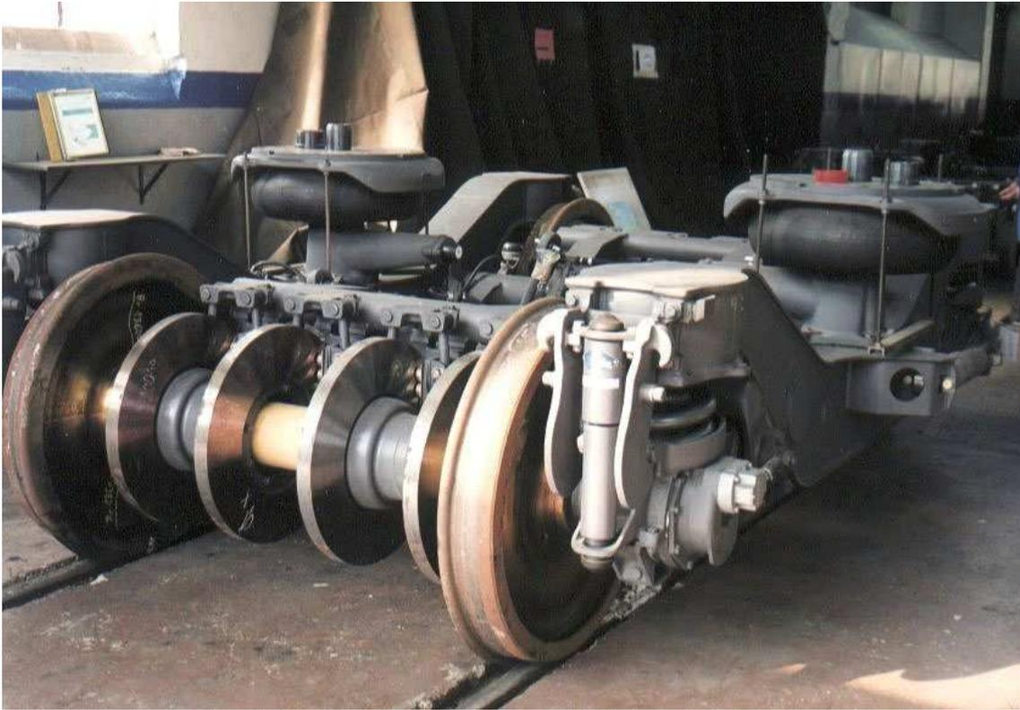
*Figura 3.7. Bogie Y237B en mantenimiento*
