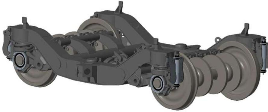
Figura 6.1. Bogie Y-237B dibujado en PTC CREO.
