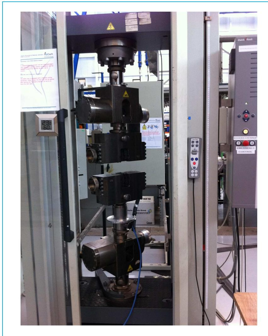
*Figure 24. Static tensile machine Zwick 250 kN*
