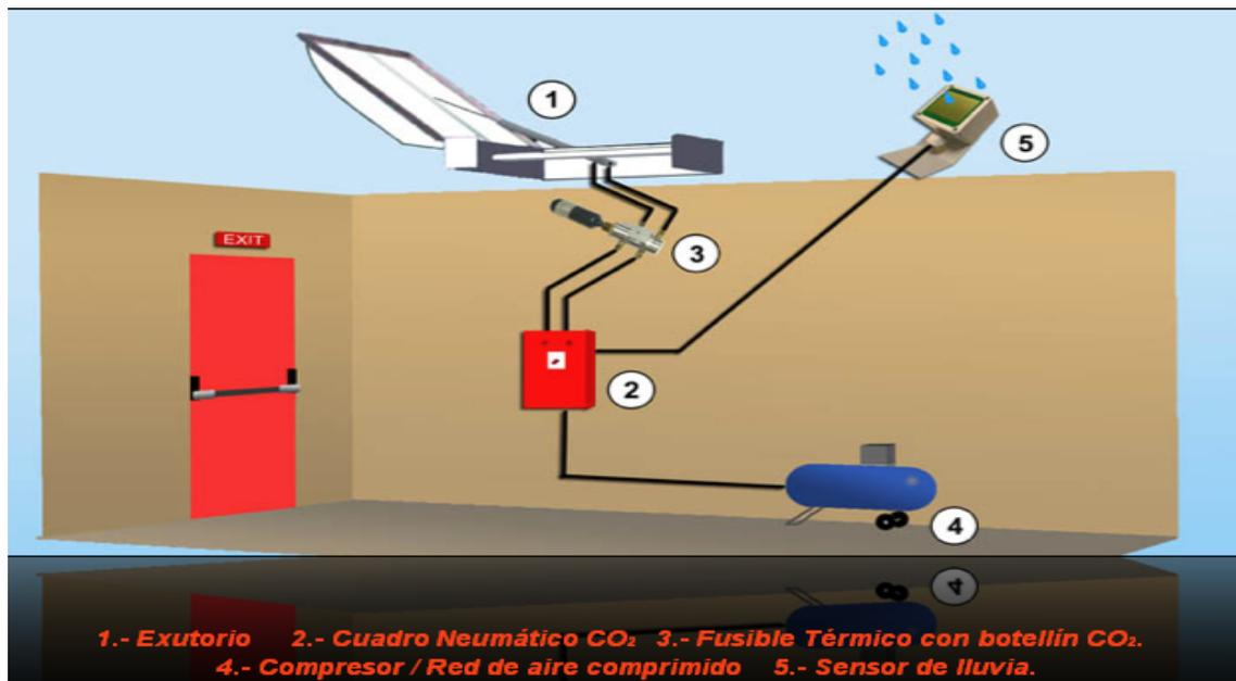
Figura 23. Esquema de principio de exutorios
