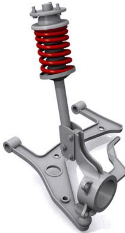
**Figura 2.29. Suspensión tipo McPherson**
