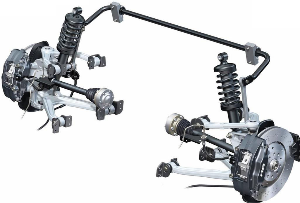
**Figura 2.26.** Suspensión actual de paralelogramo deformable de un Audi R8
