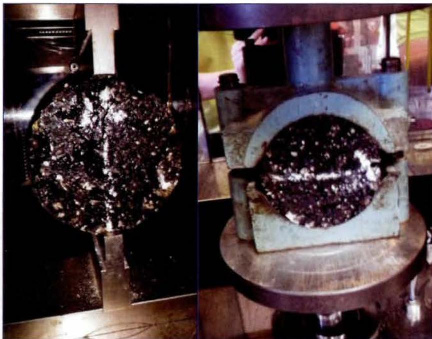
Foto 2. Rotura y recompactación de las probetas.
