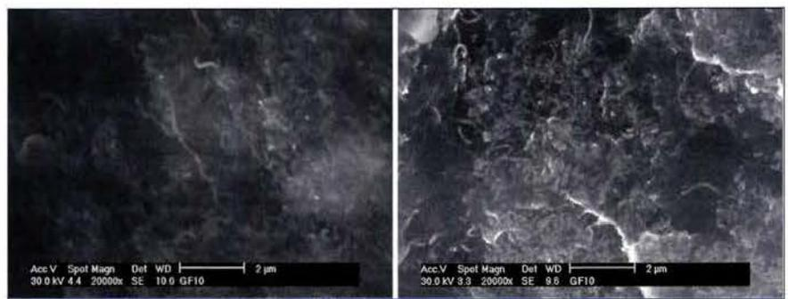
Figura 5. Fotos SEM de las dispersiones de nanotubos de carbono en betún asfáltico.
