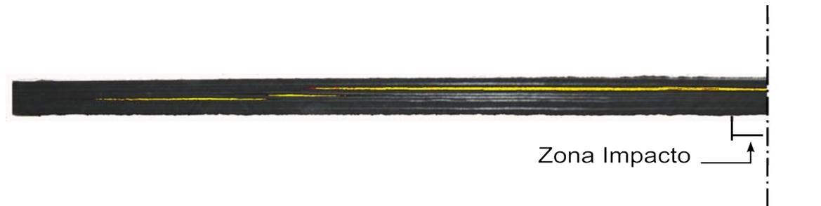
Figura 5.10: Corte transversal de una probeta de 4 mm de espesor impactada por un proyectil de 40 mm de diámetro a 193 m/s.
