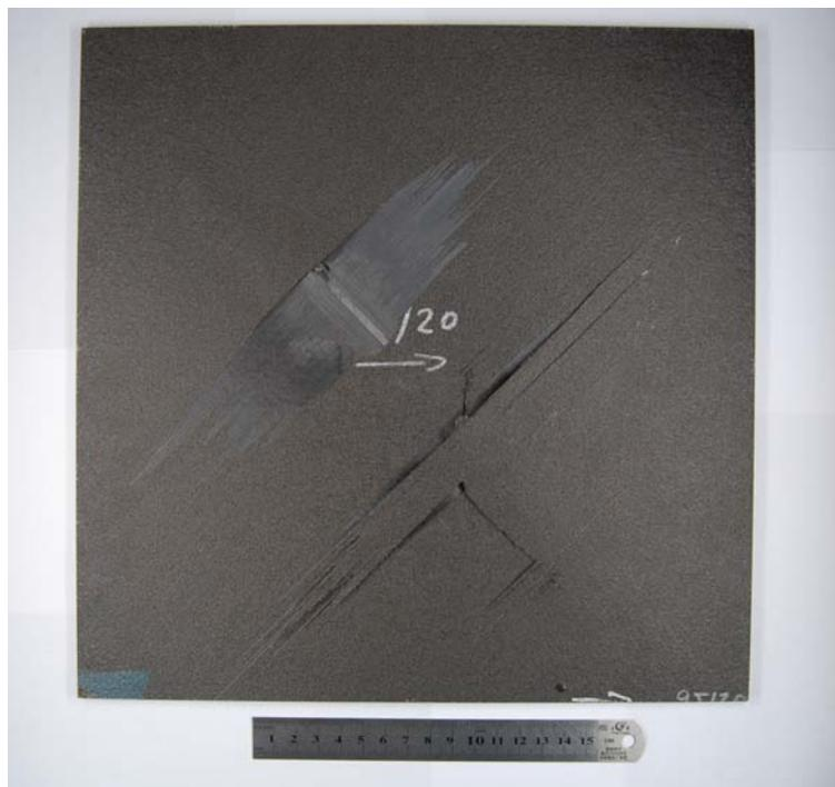
Figura 5.9: Zona de impacto de un laminado de 4 *mm* de espesor impactada por un proyectil de 50 *mm* de diámetro a 200 *m/s*.
