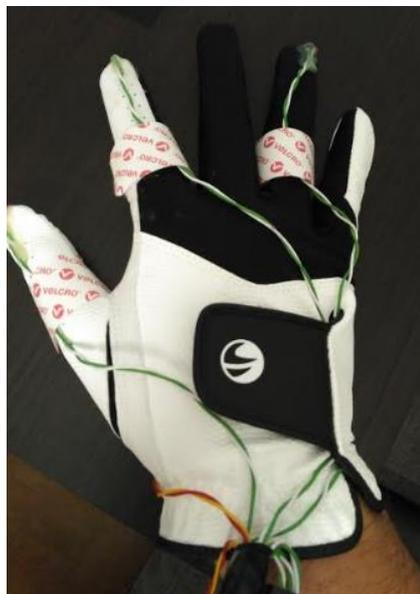
Ilustración 63. Guante háptico utilizado para la estimulación vibro táctil
