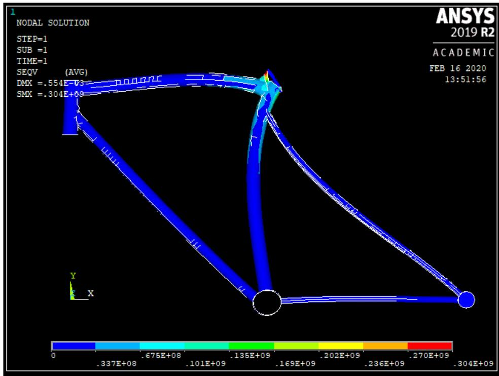
Figura 6.2. Tensión de Von Mises cuadro acero con fuerzas verticales
