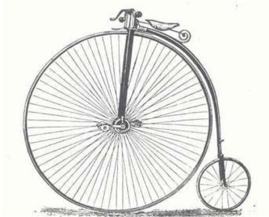
*Figura 1.4. Ilustración de bicicleta con rueda delantera de mayor tamaño*
