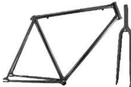
*Figura 1.20. Cuadro y horquilla de bicicleta fabricados en acero [6]*
