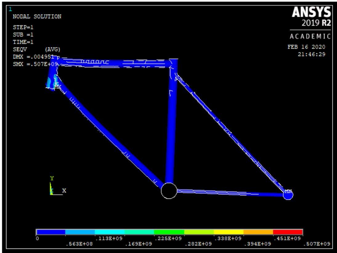
Figura 6.44. Tensión Von Mises cuadro fibra de carbono reforzada con GO con fuerzas horizontales
