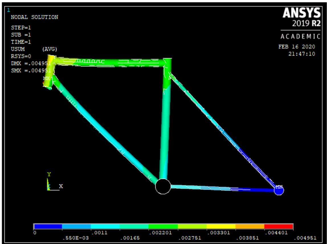
Figura 6.45. Deformación cuadro fibra de carbono reforzada con GO con fuerzas horizontales
