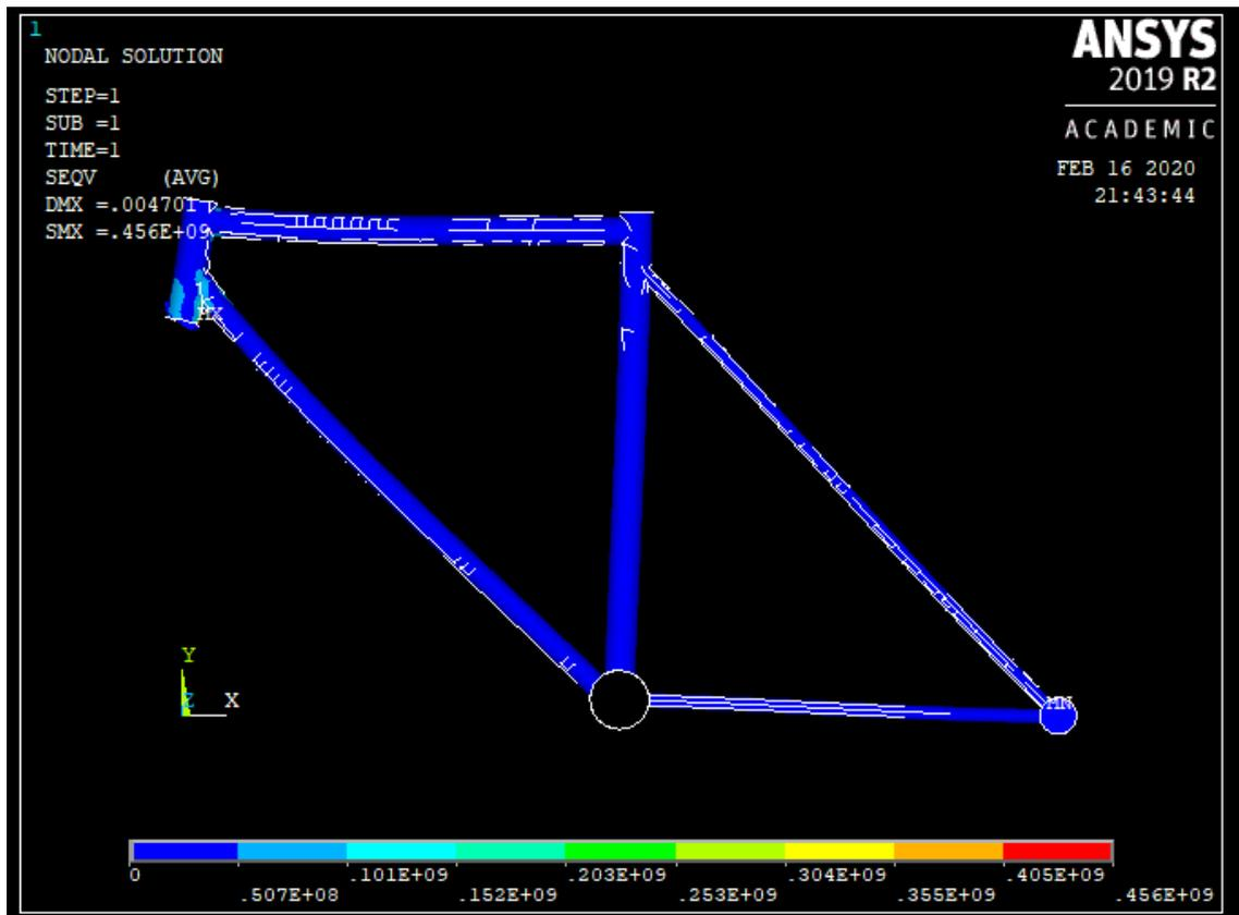
Figura 6.41. Tensión Von Mises cuadro fibra de carbono con fuerzas horizontales
