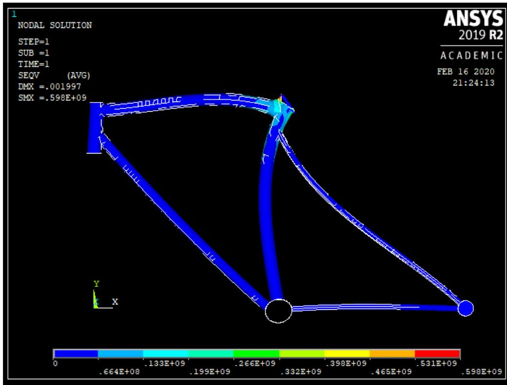
Figura 6.14. Tensión Von Mises cuadro de fibra de carbono reforzada con GO con fuerzas verticales
