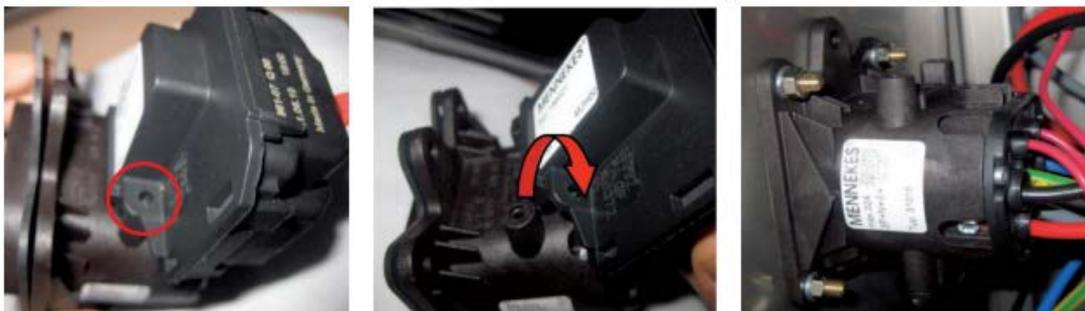
Figura 79. Proceso de colocación del conector.
