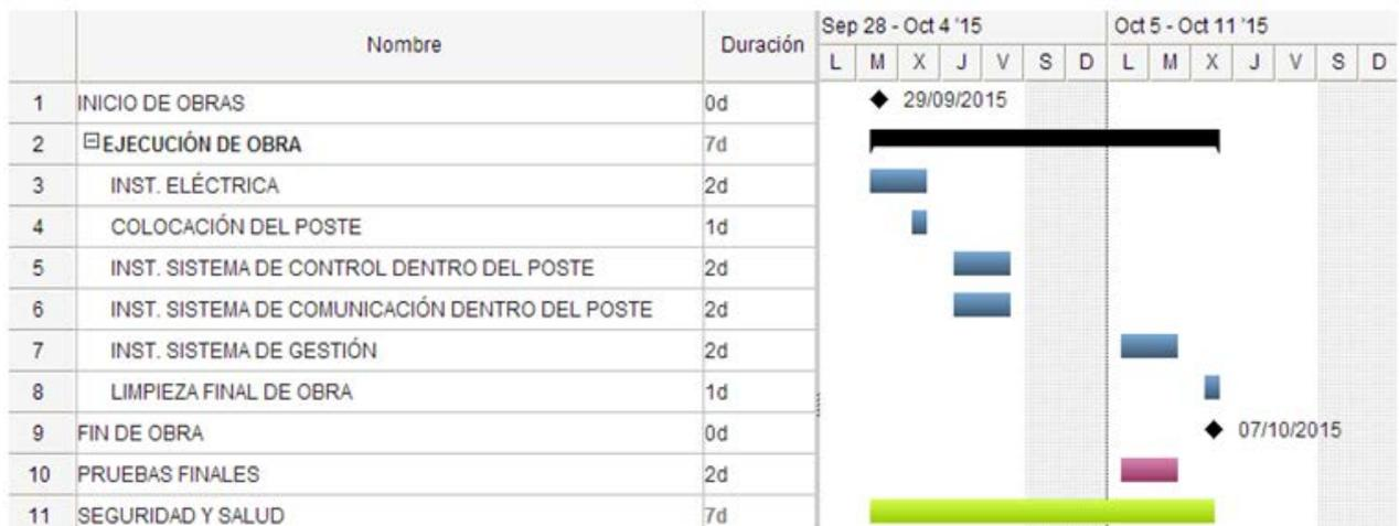
Figura 76. Diagrama de Gantt de la instalación de las infraestructuras de recarga.
