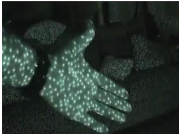
**Figura 15:** Lanzamiento de rayos infrarrojos de Kinect
