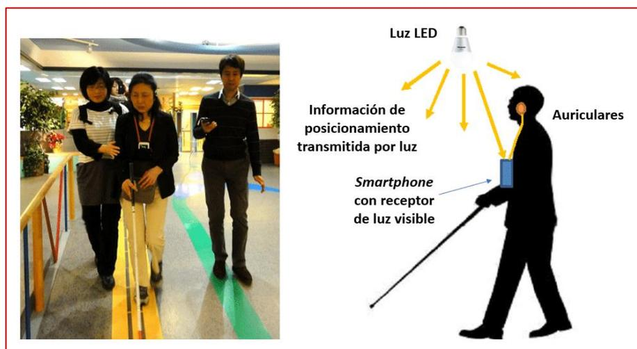
Fig. 3.12. Utilización de la VLC para guiar a un invidente
