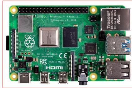
Fig. 4.2. Raspberry Pi 4 Modelo B
