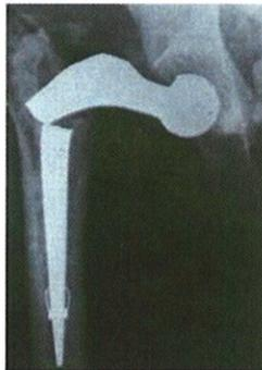
Imagen 19.: Radiografía de una prótesis de cadera fallada por fatiga
