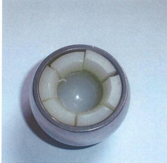
Imagen 34.: Fotografía del núcleo de polietileno patrón
