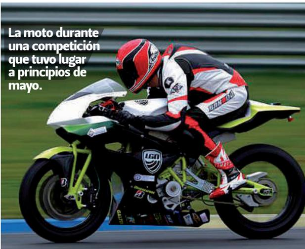
El proyecto e-Moto, nace como un vehículo concebido desde la base para ser motocicleta eléctrica, con unos sistemas de recarga de baterías con resultados más que sorprendentes, similares a los de un automóvil. Destaca su ligereza respecto a otros modelos existentes (145 Kg.), un motor de corriente alterna con una potencia máxima de unos 95 caballos, un sistema de recarga de las baterías a través de las frenada
