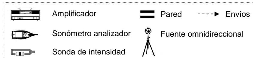
En el momento de decidir sobre los locales emisor y receptor, se empleará el mismo criterio del método clásico, empleando en este caso una potencia de fuente algo mayor que en el caso del método tradicional, para aumentar el nivel y así la calidad de las adquisiciones en el local receptor, pero sin generar transmisiones indirectas demasiado elevadas.
