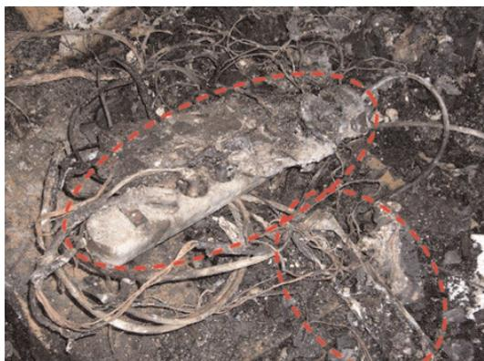
**Fotografía 13.** Dos regletas de enchufes conectadas en serie a la toma de corriente de la pared del mueble del salón.
