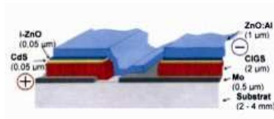
*Fig 3.3.9.2.1 Estructura de un módulo tipo CIS*
