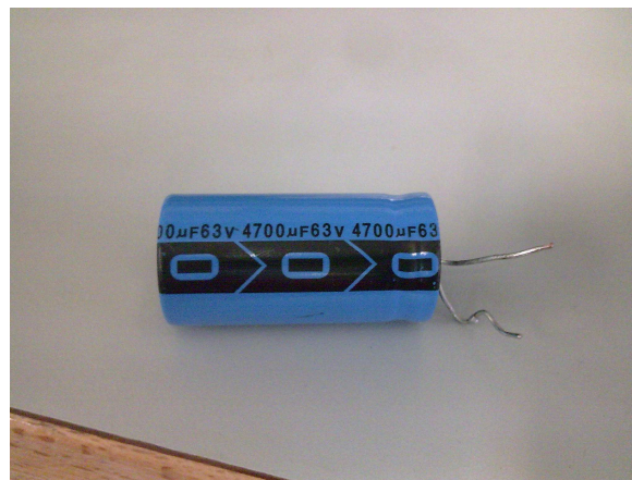
Figura 29 Imagen del modelo de condensador empleado en el módulo de 65V
