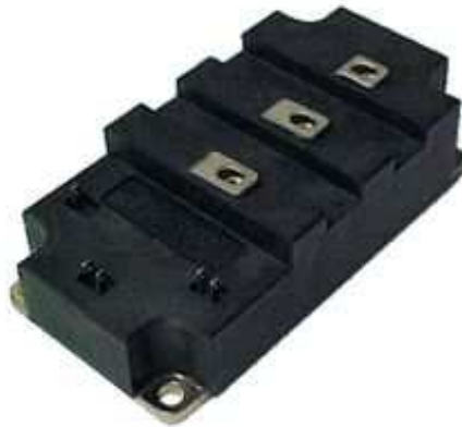
Figura 75 Imagen de un módulo IGBT de capacidad 1000V y 250A
