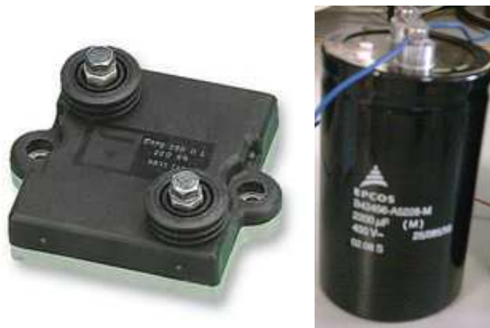
Figura 35 Imagen de la resistencia de potencia empleada y de uno de los condensadores
