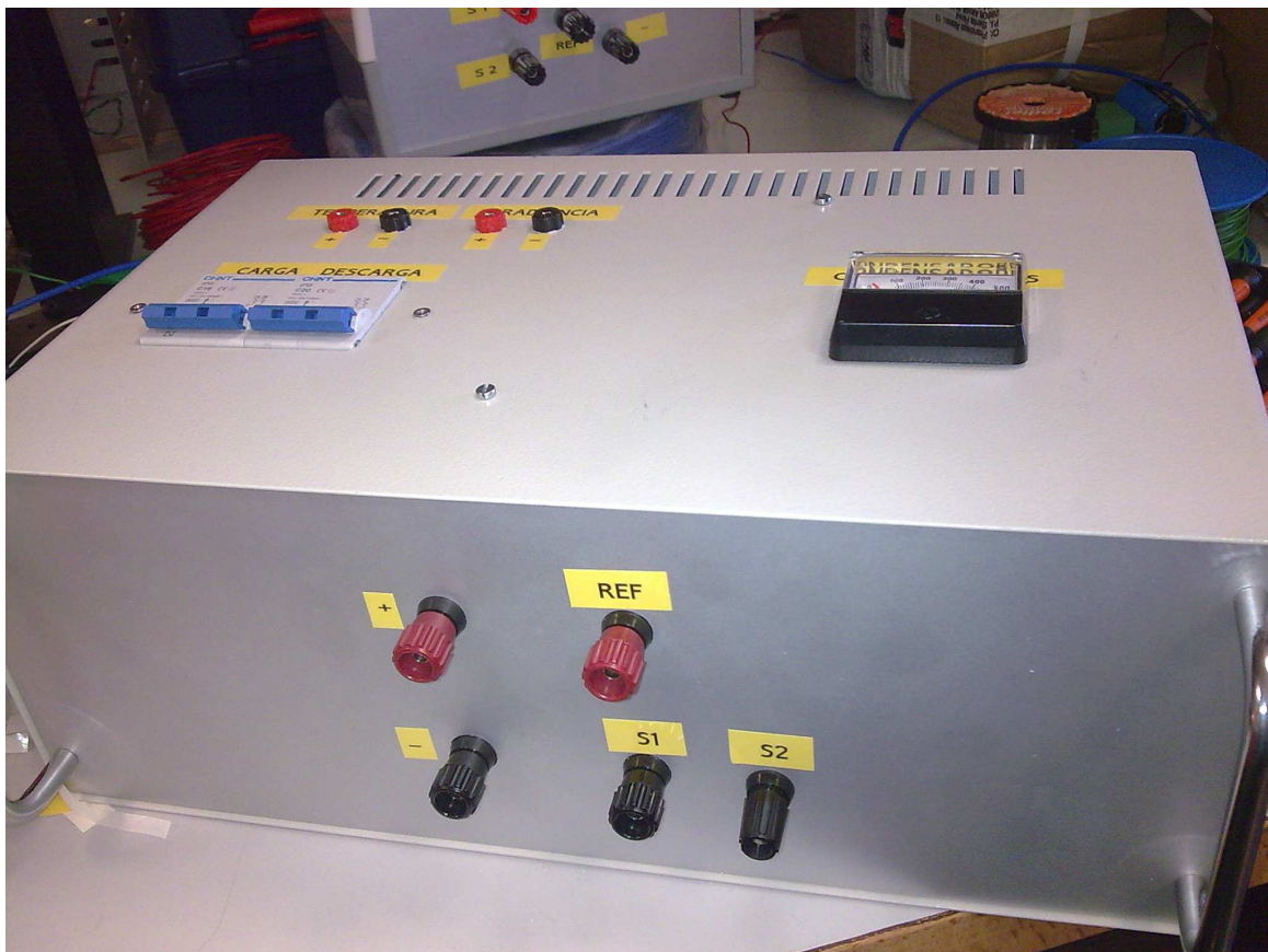
Figura 34 Fotografía del dispositivo portátil de medida de 400V
