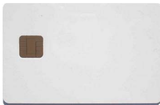
Figura 3-1: TII de contacto genérica acorde con la norma ISO/IEC 7810, aún sin las características exteriores impresas/grabadas
