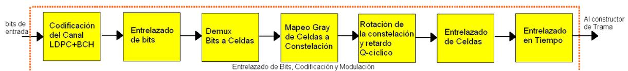
Figura 3.1: Módulos que conforman el bloque BICM
