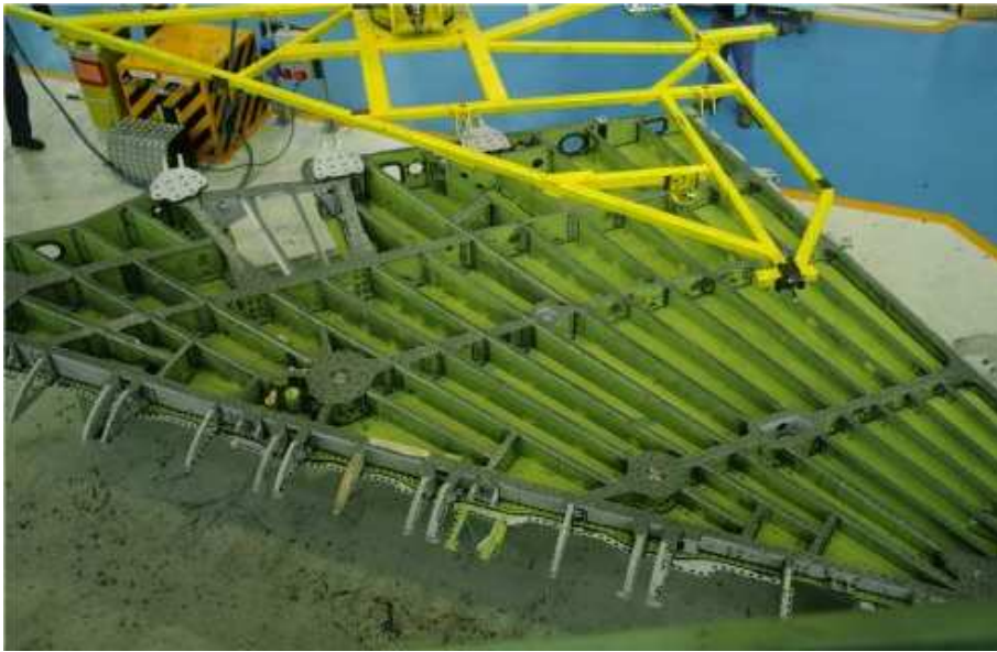
Figura 2.4: Estructura de ala de Eurofighter Typhoon ( www.eurofighter.com ).
