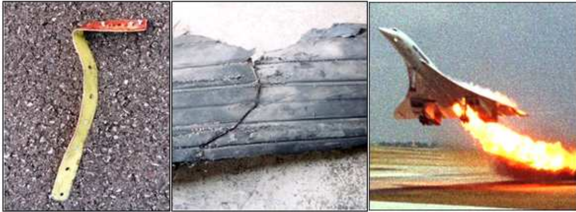
Figura 1.3: Accidente del Concorde en el año 2000. Izqda.: Fragmento metálico origen del reventón. Centro: Restos del neumático. Dcha.: Concorde en llamas ( www.primeraclase.com ).
