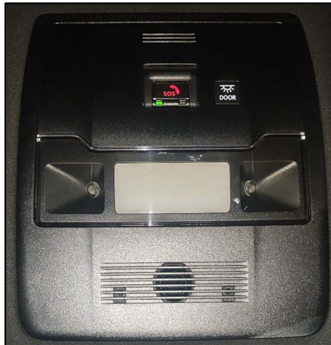
Figura 6: ejemplo de ubicación de módulo e - call
