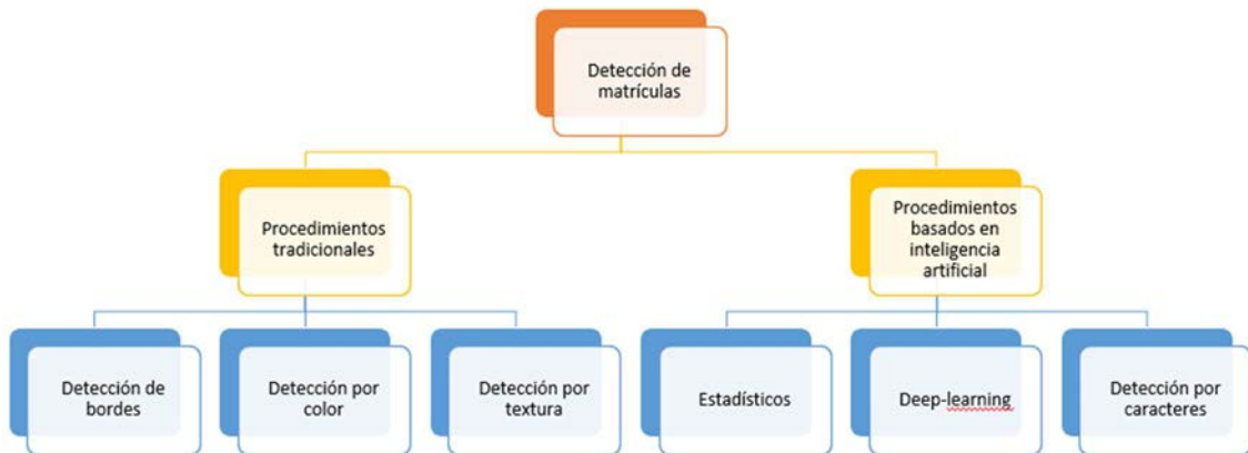
Figura 13: esquema de procedimientos de detección de matrículas
