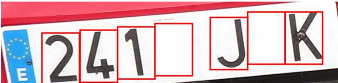
Figura 48: detalle del etiquetado visual de los caracteres de la matrícula
