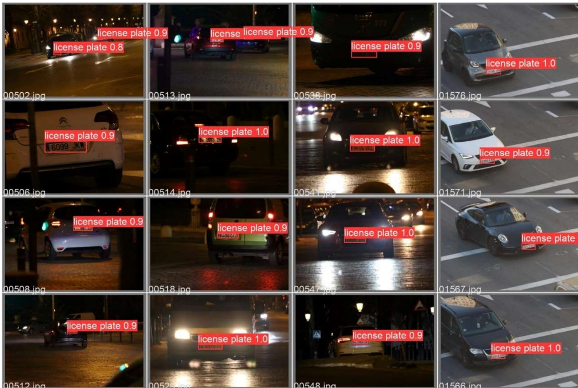
Figura 55: detalle del proceso de detección de matrículas
