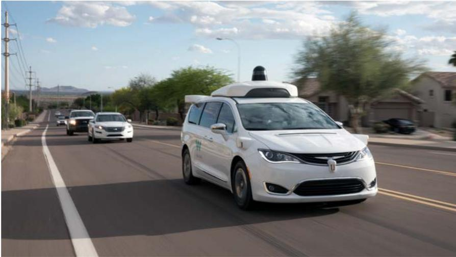
Figura 2.3: Vehículo autónomo de la empresa Waymo (Fuente: Waymo).
