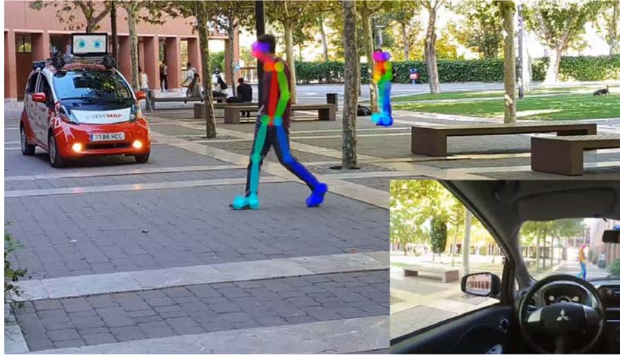
Figura 6.2: Interacción entre un peatón y el VA junto con la detección de la posición del peatón.
