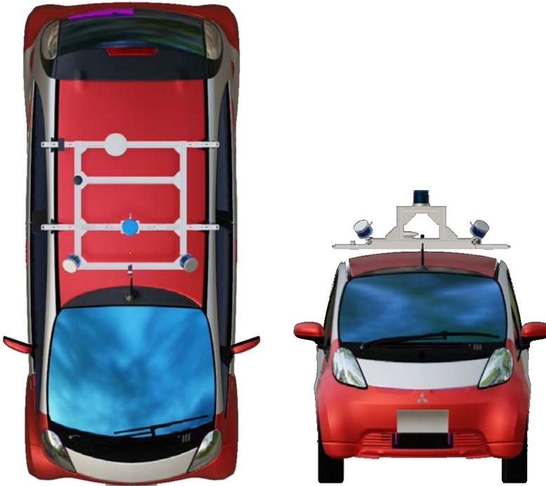
Figura 3.3: Planta y alzado del modelo virtual del vehículo donde se puede apreciar la colocación de los sensores.
