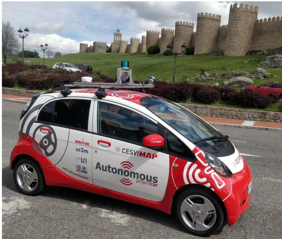
Figura 3.1: Plataforma de VA basada en un Mitsubishi iMiev.
