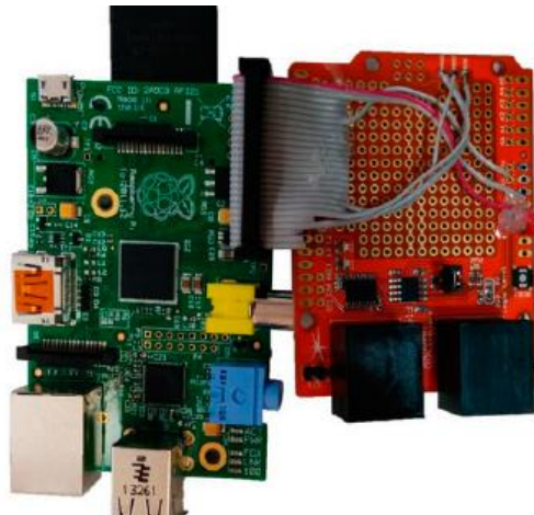
Figura 11: Primer prototipo del proyecto SIMBA, basado en una placa Raspberri Pi2.
