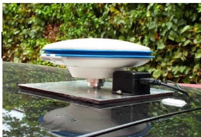
Figura 15: IMU y GPS instalado en el IVVI 2.0
