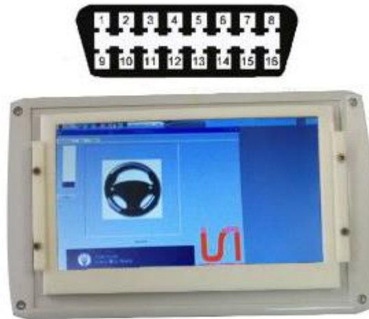
Figura 21: El conector OBDII (arriba) y el prototipo final de sistema lector CAN bus (SIMBA)
