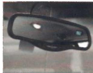
Figura 4. Espejo retrovisor electrocrómico con sensor de temperatura (Fahrenheit).
