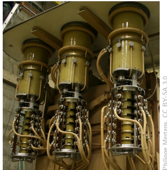
Figura 3.19: Cambiadores de tomas, uno por fase, en un transformador trifásico desencubado. Los cambiadores cuelgan de la tapa de la cuba del transformador. En la parte inferior se encuentra el selector y en la parte superior, dentro de un cilindro, el conmutador.
