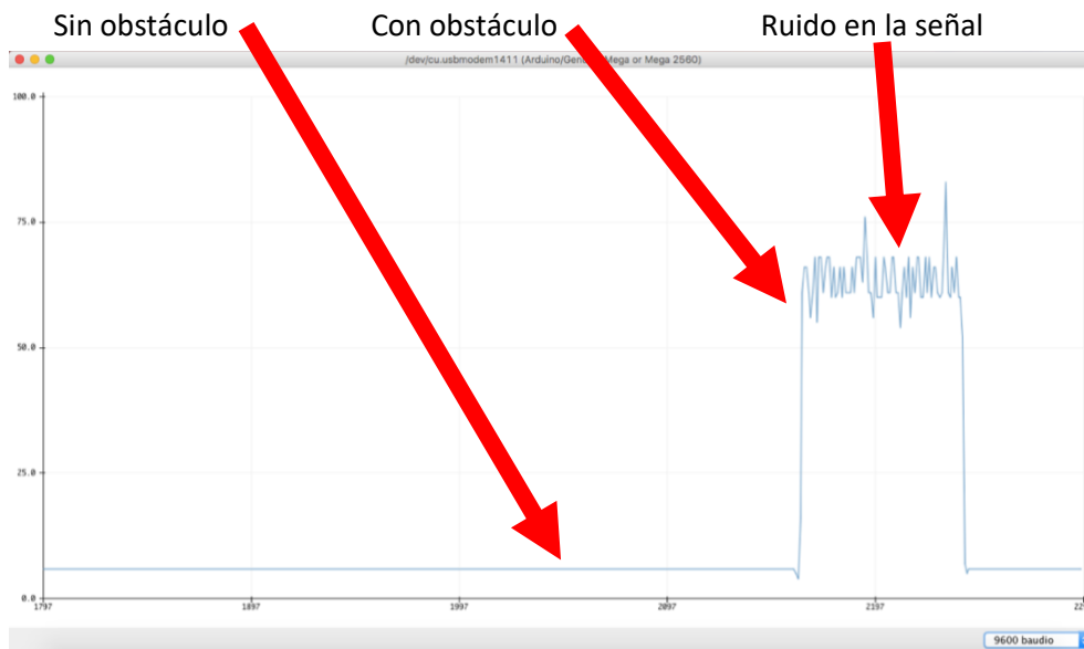
Ilustración 43 Representación con la función Serial Plotter del sensor Sharp
