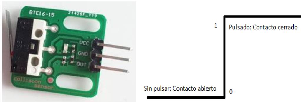
Ilustración 10 (a) Sensor de colisión y (b) ejemplo de señal que genera
