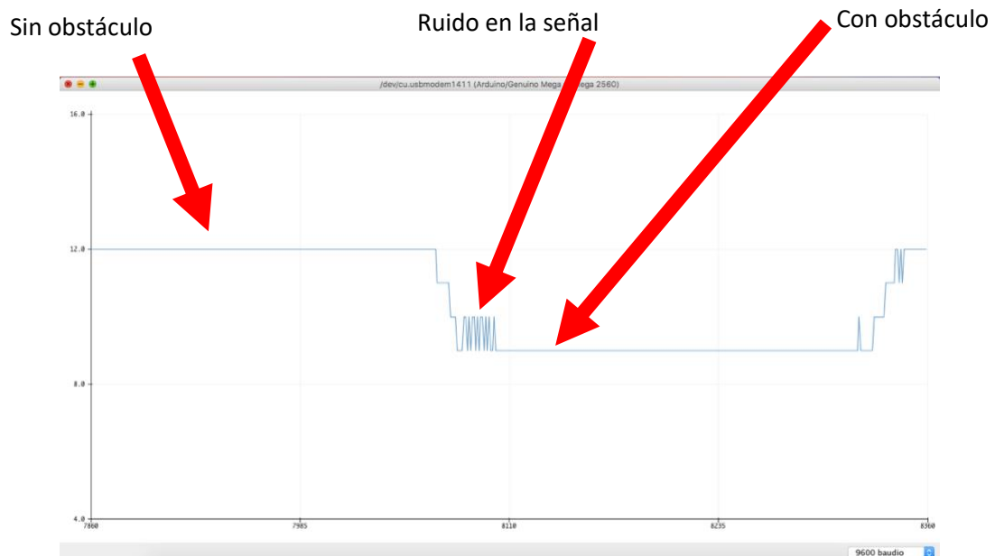
Ilustración 44 Representación con la función Serial Plotter del sensor de ultrasonidos
