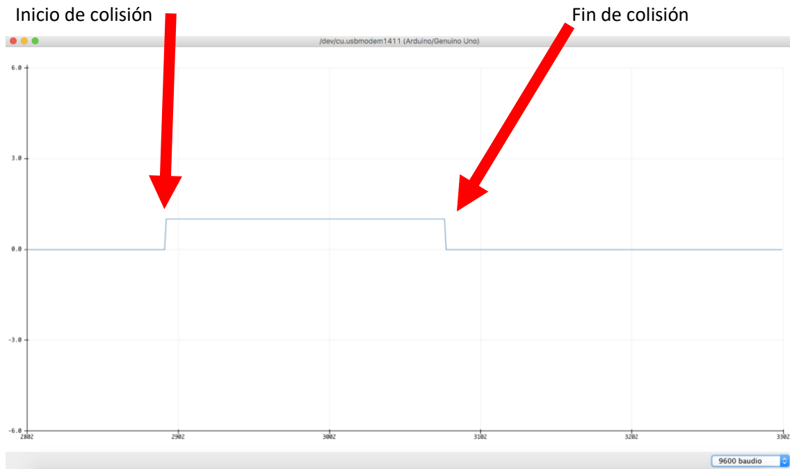
Ilustración 41 Representación con la función Serial Plotter del sensor de colisión
