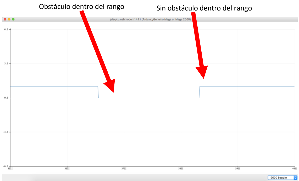
Ilustración 42 Representación con la función Serial Plotter del sensor de infrarrojos de proximidad
