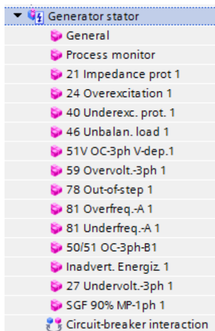
Ilustración 7-2: Grupo de función “ Generator stator ” en DIGSI 5
