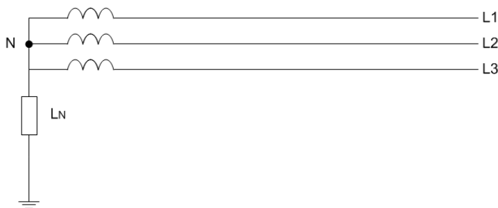
Ilustración 4-7: Neutro puesto a tierra a través de una baja reactancia de PAT
