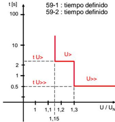
Ilustración 5-31: Curva característica de disparo de la protección de sobretensión (59) [9]
