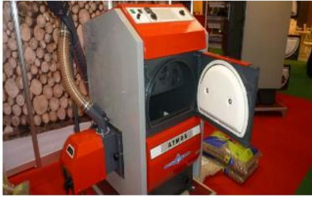
*Ilustración 23: ejemplo de quemador de biomasa*
