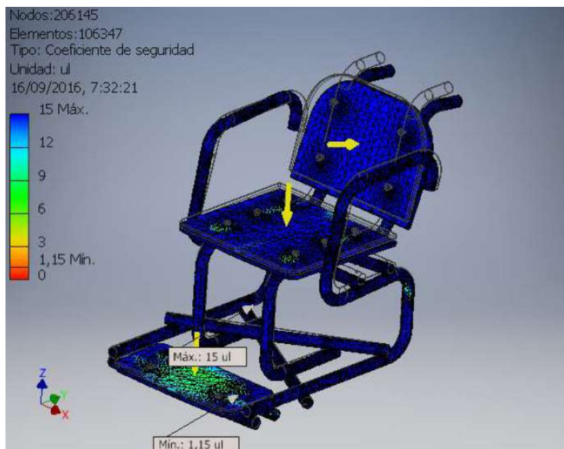
Ilustración 58. Factor de seguridad en la prueba crítica 1.
