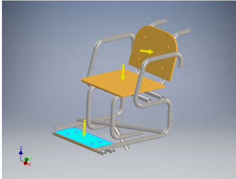
Ilustración 57. Dirección y magnitud de Fuerza 2 prueba crítica.
