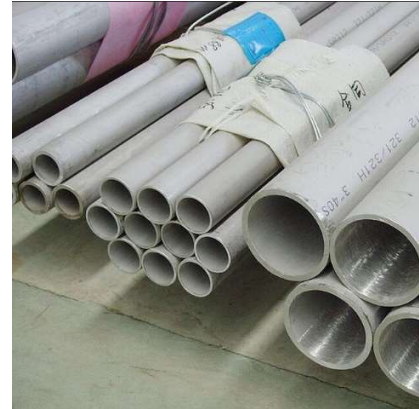
Ilustración 8. Tuberías de acero inoxidable excedentes.
