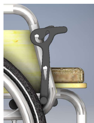
Ilustración 43. Prototipo de freno en posición activado.
