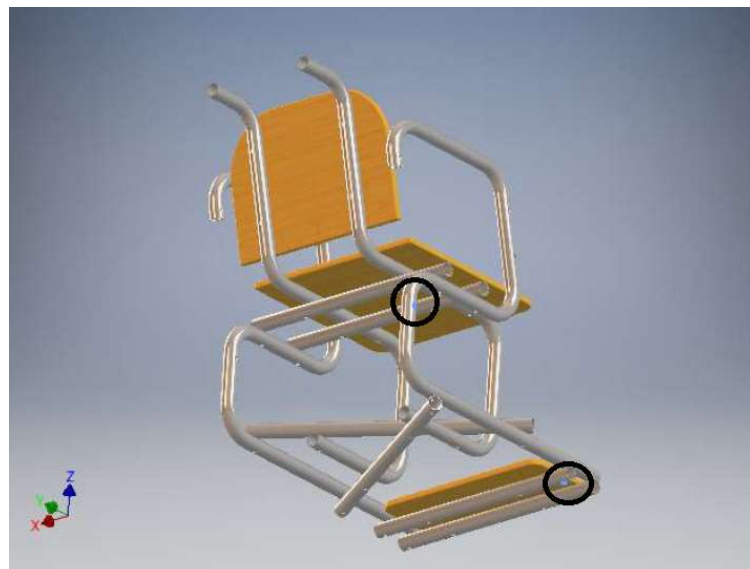
Ilustración 60. restricciones fijas de la prueba crítica 2.
