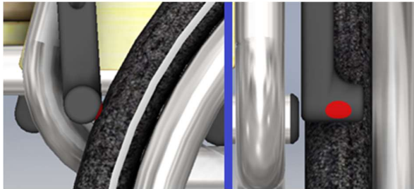
Ilustración 45. Frontal y lateral de la superficie de contacto del freno activado.
