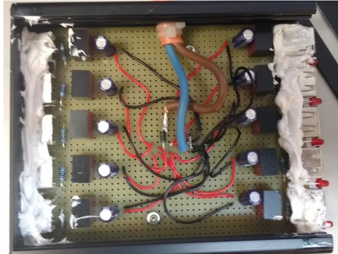
Figura 38: Proceso de fabricación del cargador: Sellado de las salidas USB y conexión de las 10 etapas a +12VDC y GND
