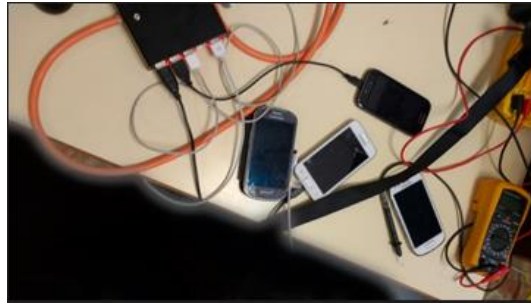
Figura 39: Prueba de carga de 4 móviles simultáneamente
