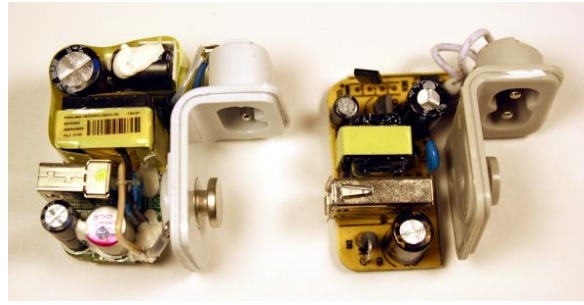
Figura 6: Cargadores comunes AC-DC (Apple vs. Marca blanca) [9]
