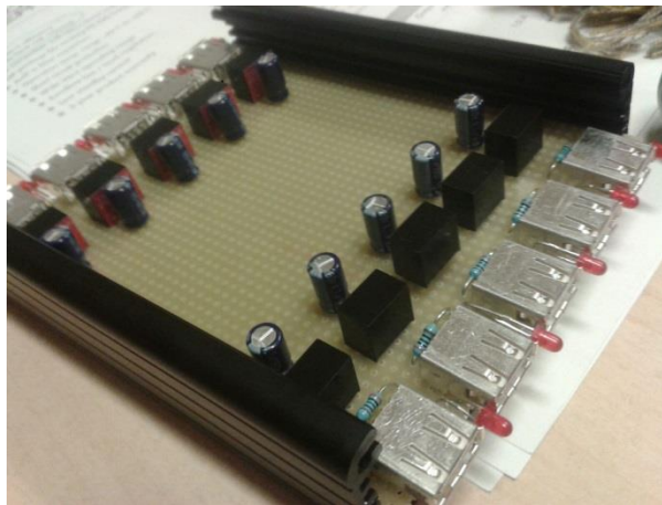
Figura 37: Proceso de fabricación del cargador: Disposición de los componentes en la placa
