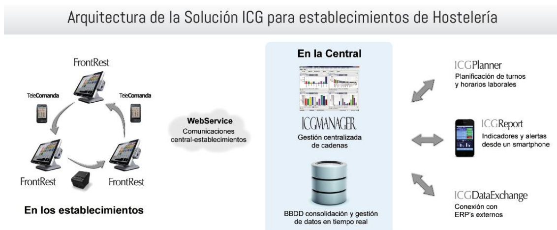
Ilustración 76. Conexiones entre los terminales y la central
