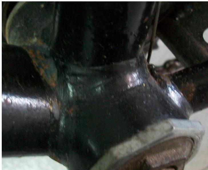
**Figura 5-5. Imagen de soldadura del tubo del asiento y del tubo inferior, con el tubo del pedalier.**
