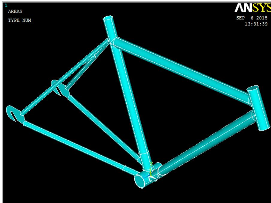
**Figura 6-33. Modelo con elementos Solid185 y Shell181.**
