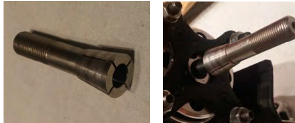
Figura 8.32 Prolongación del eje principal del motor.
