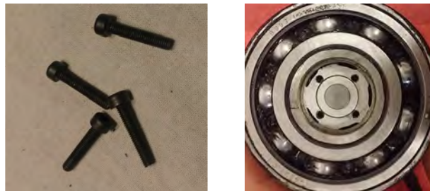
Figura 8.28 Tornillos de sujeción del eje auxiliar del motor.
