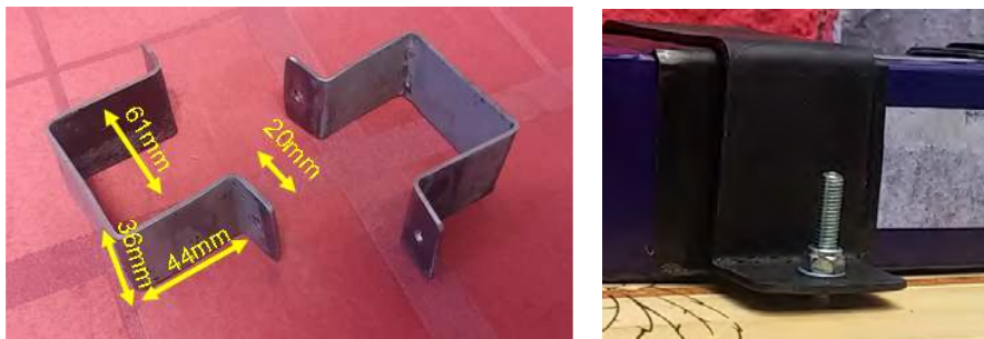
Figura 8.39 Bridas de sujeción de la batería.
