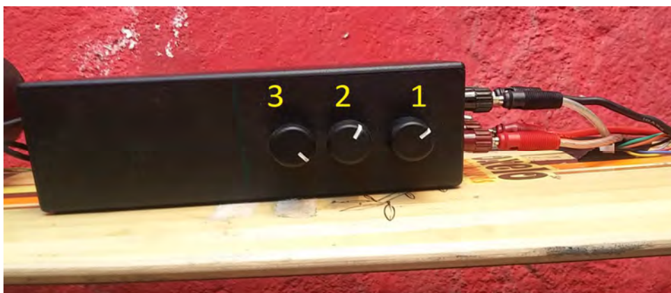
Figura 4.40 Potenciómetros ajuste prestaciones dinámicas.
