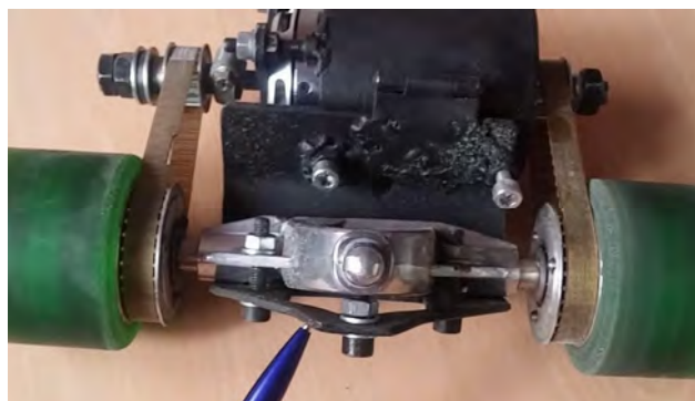
Figura 4.15 Tornillo de regulación de altura del motor
