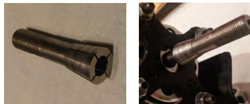
Figura 8.59 montaje de la prolongación del eje principal del motor
