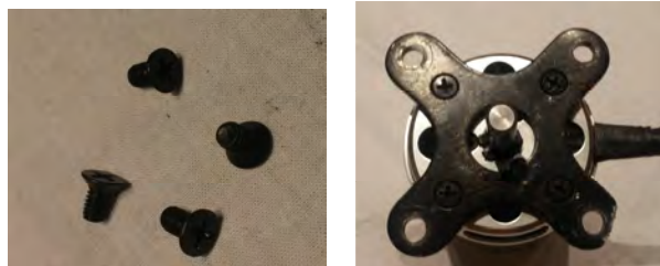
Figura 8.24 tornillos de sujeción del anclaje original del motor al estator.
