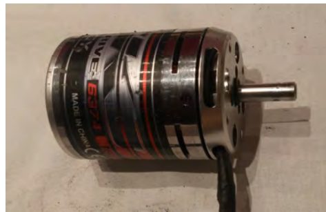
Figura 8.21 Motor eléctrico Turnigy Aerodrive SK3 - 6374-168kv Brushless (sin escobillas)
