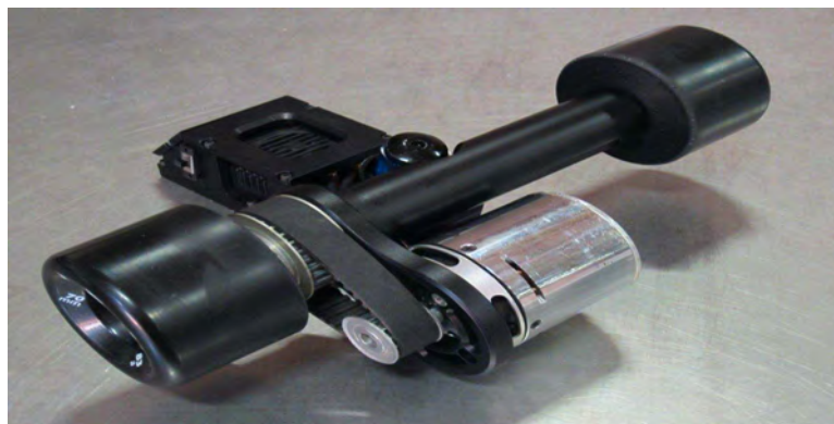
Figura 2.8 Detalle de longboard con tracción por correa y poleas
