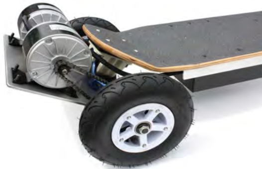
Figura 2.9 Detalle de longboard con tracción por cadena y piñón-corona
