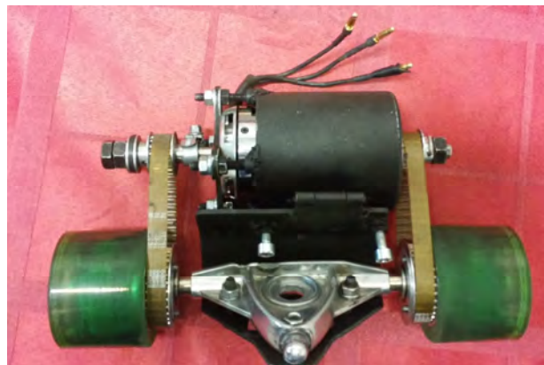
Figura 4.21 Situación de poleas conductoras en motor eléctrico.
