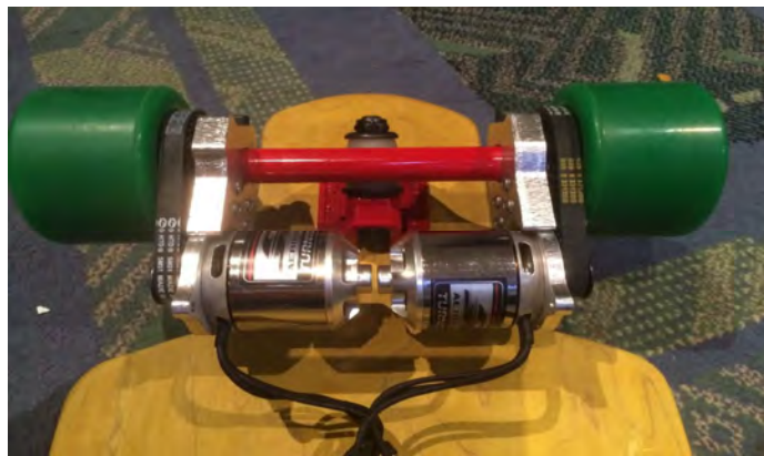
Figura 2.2 Detalle de longboard con tracción a dos ruedas
