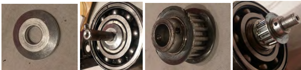
Figura 8.57 Secuencia de montaje de la polea conductora en motor eléctrico
