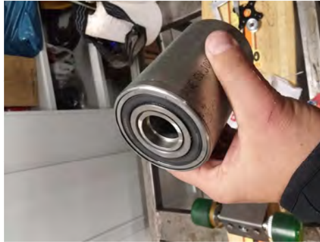
Figura 4.11 Detalle del rodamiento en carcasa metálica protectora
