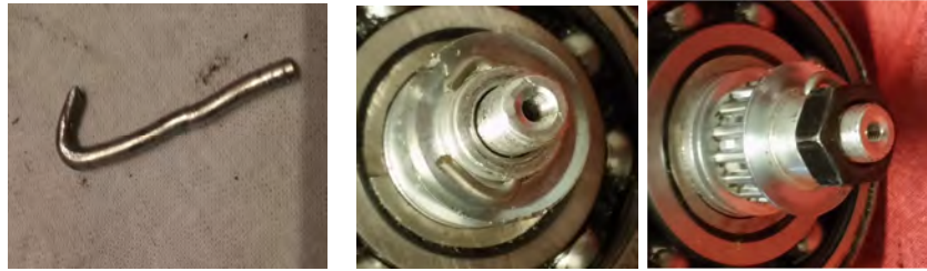
Figura 8.58 Fijación de polea conductora en el eje auxiliar del motor.
