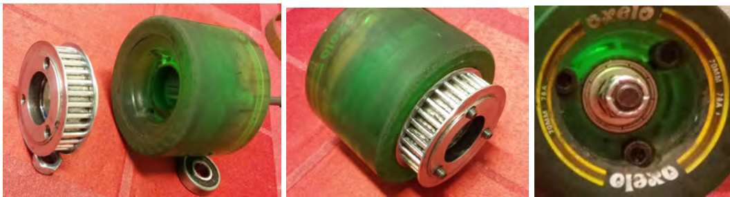
Figura 8.49 Secuencia de montaje de las poleas conducidas en las ruedas traseras.
