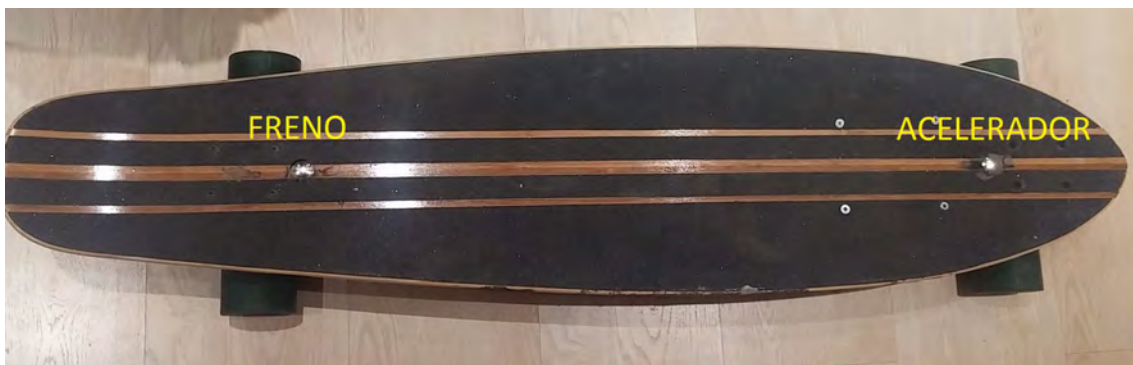
Figura 4.36 Control por pulsadores situados en la superficie de la tabla
