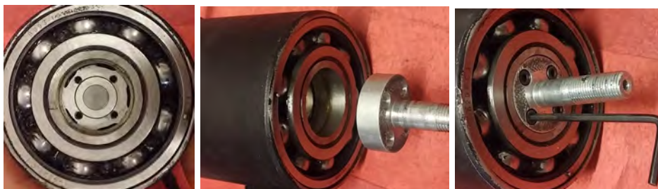
Figura 8.55 secuencia de montaje del eje auxiliar del motor.
