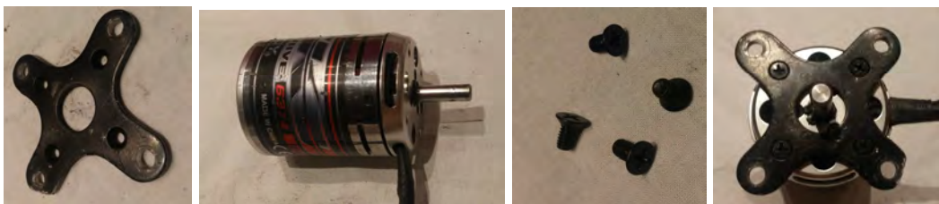
Figura 8.53 secuencia de montaje del anclaje original en el cuerpo del motor,
