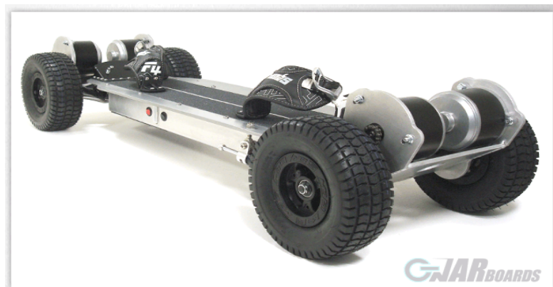
Figura 2.3 Detalle de longboard con tracción a las cuatro ruedas
