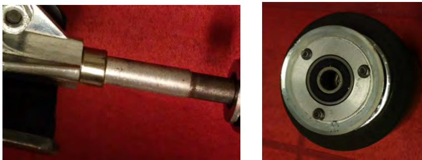
Figura 4.18 Mecanizado de eje y poleas para acople de rodamiento
