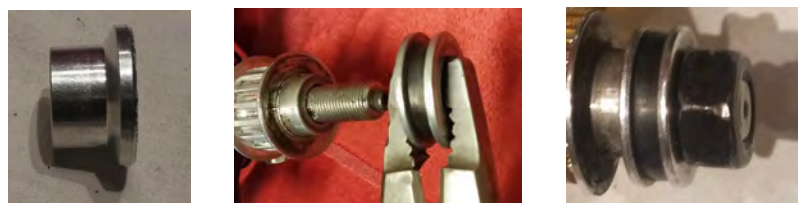
Figura 8.60 montaje de polea conductora y embrague de fricción
