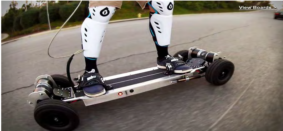
Figura 2.4 Detalle de longboard con mando por cable
