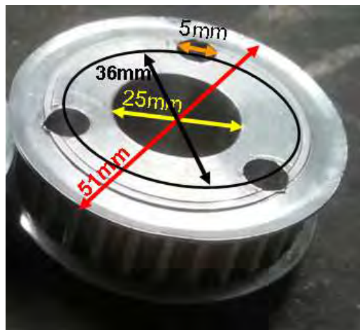
Figura 8.14 Polea conducida de rueda trasera.
