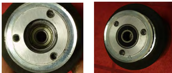
Figura 8.50 montaje de rodamiento auxiliar en poleas conducidas.
