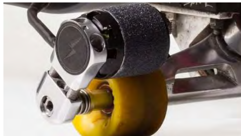
Figura 2.7 Detalle de longboard con tracción directa entre motor y rueda
