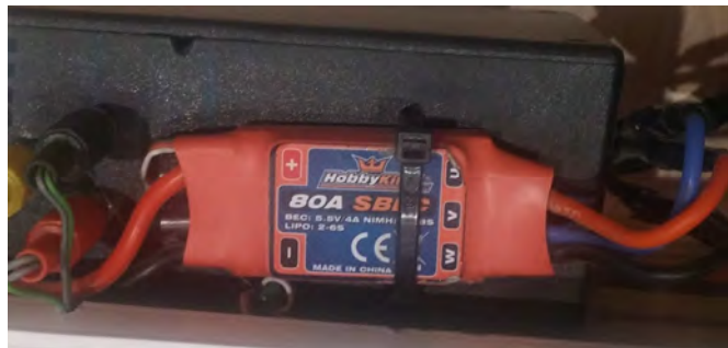
Figura 8.66 Fijación del ESC a la caja eléctrica.
