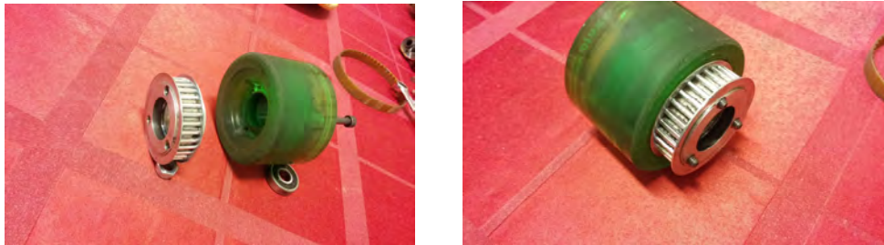
Figura 4.17 Acople de las poleas conducidas en las ruedas traseras
