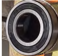
Figura 8.25 rodamiento auxiliar del motor
