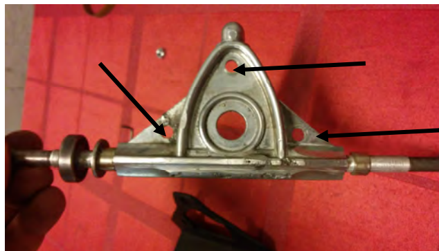
Figura 4.6 Taladros en eje trasero donde se fija el soporte del motor
