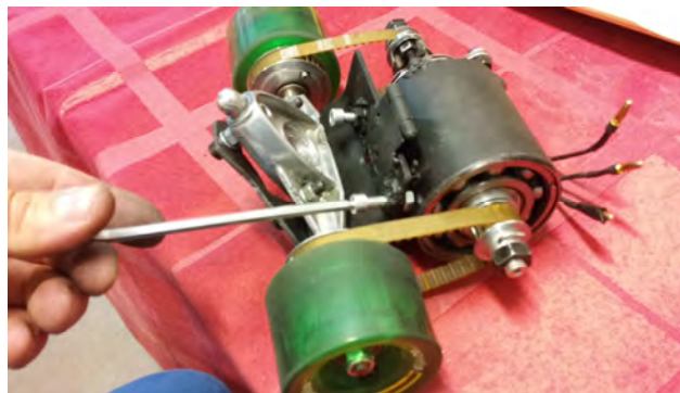
Figura 4.14 Ejemplo de tensado de correas
