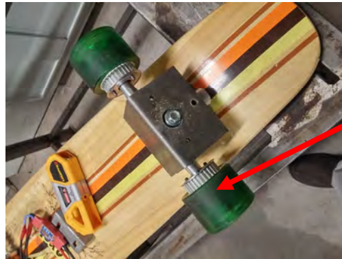
Figura 4.7 Primer replanteo del soporte del motor en el eje trasero.
