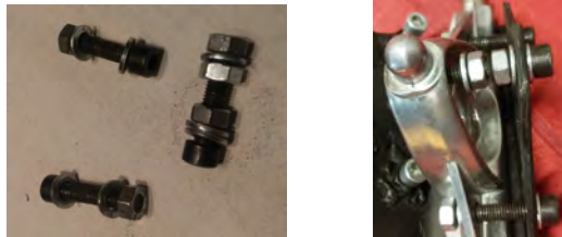
Figura 8.35 Tornillos de sujeción del soporte motor al eje
