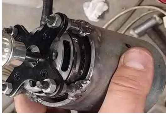
Figura 4.12 Detalle de los cuatro espárragos para fijación de motor a carcasa
