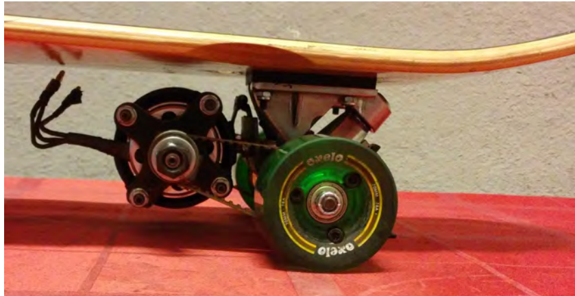
Figura 4.5 Detalle distancia libre entre motor-suelo y entre motor-tabla
