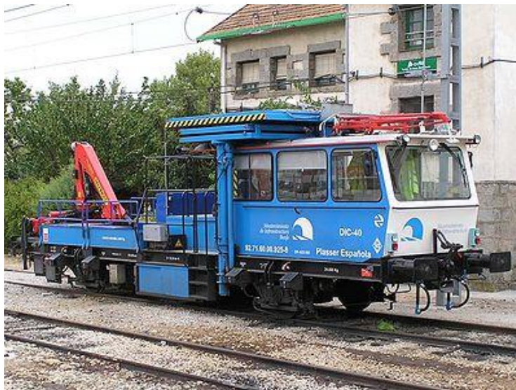
Figura 1: Dresina Plasser de electrificación [1]
