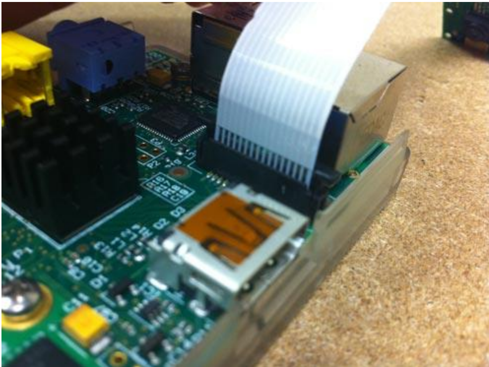
Ilustración 22 - Detalle de colocación de la cámara - vía thepihut.com
