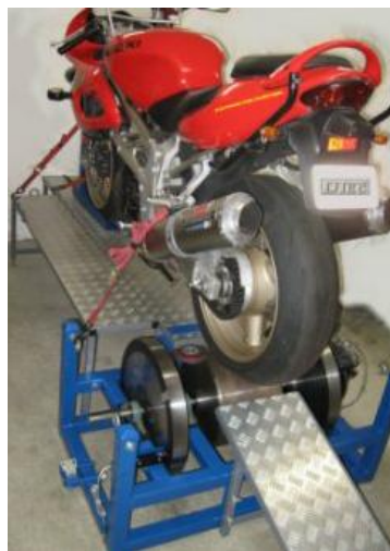
Fig6. Ejemplo de dinamómetro comercial para motocicletas de DTEC DIY DYNO
