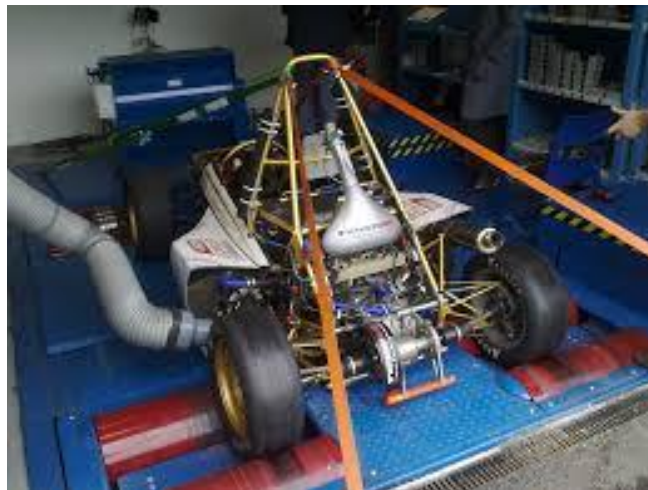
Fig17. Montaje típico en un banco de potencia
