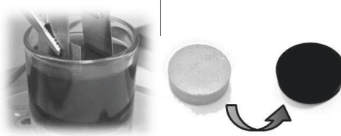
Figura 2. Deposición de TiN mediante EPD sobre sustratos sinterizados de titanio pulvimetalúrgico.
