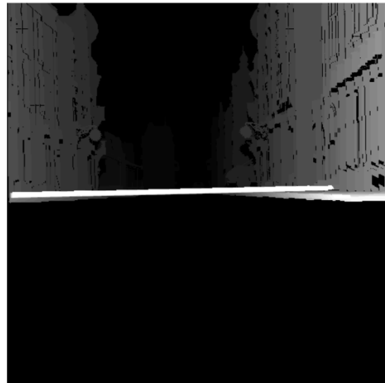
Figura 5.12. (a) Esquema del cambio de la situación del sistema estéreo en la construcción del mapa de disparidad virtual. Imagen procedente de [35]. (b) Mapa de disparidad original (Ecuilizado). (c) Mapa de disparidad virtual (Ecuilizado).
