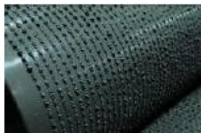
Figura 2.9. Superficie de un rodillo realizado con soldadura sin gas
