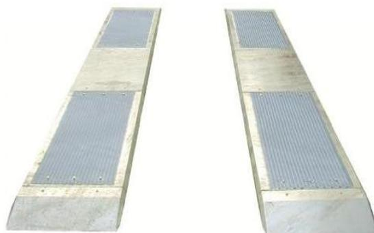
Figura 2.3. Frenómetro de placas (4 placas)
