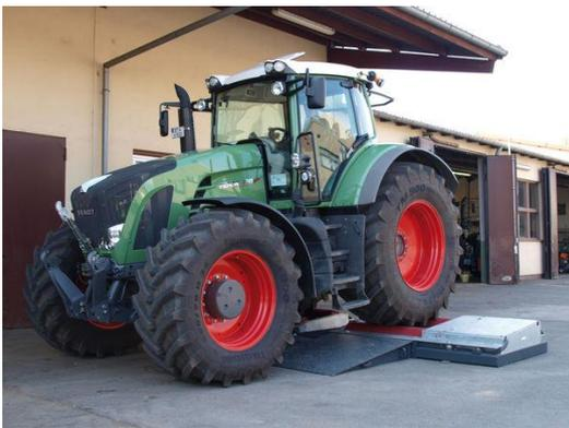
Figura 2.11. Frenómetro universal (tractor)
