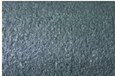
Figura 2.7. Superficie de un rodillo galvanizado en caliente y con revestimiento de plástico y corindón
