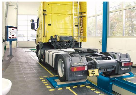
Figura 2.12. Frenómetro universal (camión)
