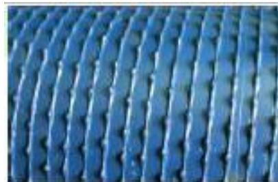
Figura 2.8. Superficie de un rodillo realizado con soldadura con gas
