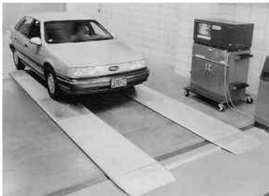
Figura 2.1. Frenómetro de placas
