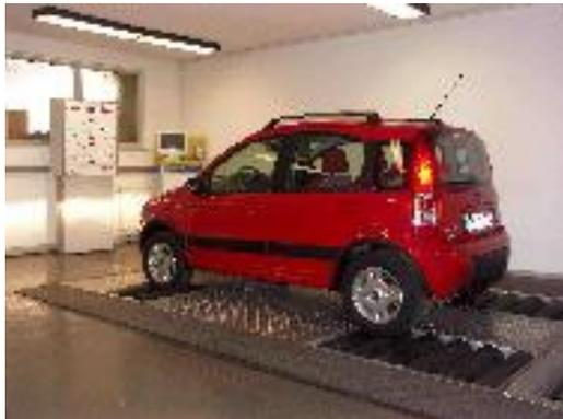
Figura 2.16. Frenómetro de rodillos con tres pares de rodillos
