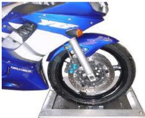
Figura 2.13. Frenómetro de rodillos con un único grupo de rodillos
