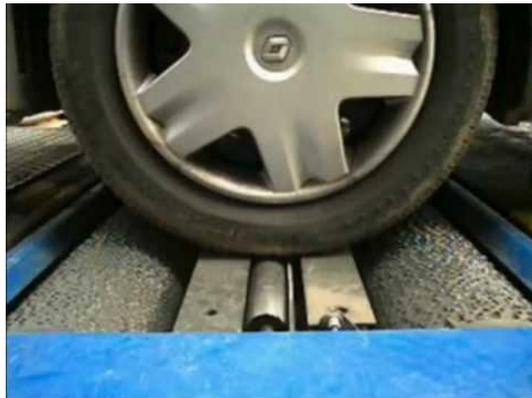
Figura 3.7. Colocación de la rueda del vehículo sobre los rodillos del frenómetro
