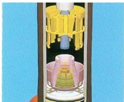
Figura 7: Inyección SF<sub>6</sub>
