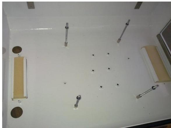
*Figura 3. 11 Pilaretes de sujeción placa de aluminio*
