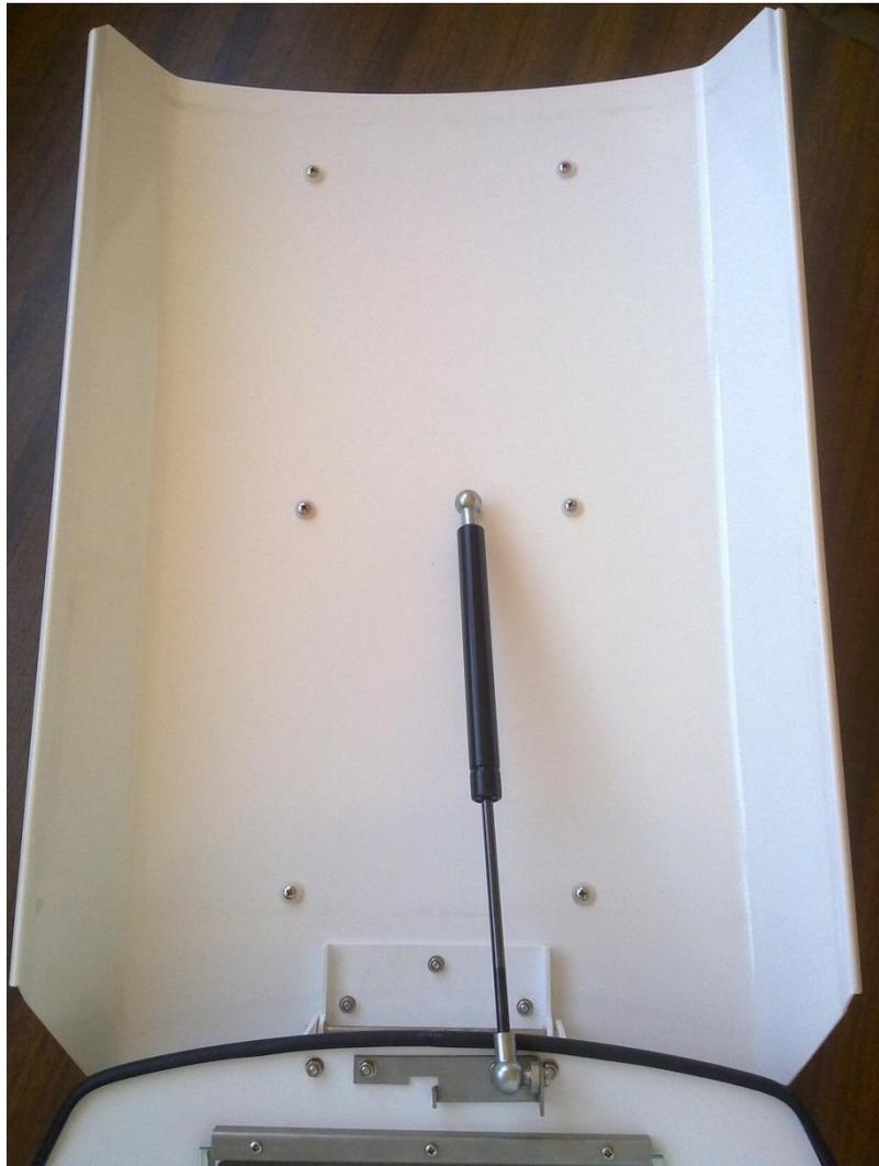
*Figura 3. 7 Eje neumático Puerta*
